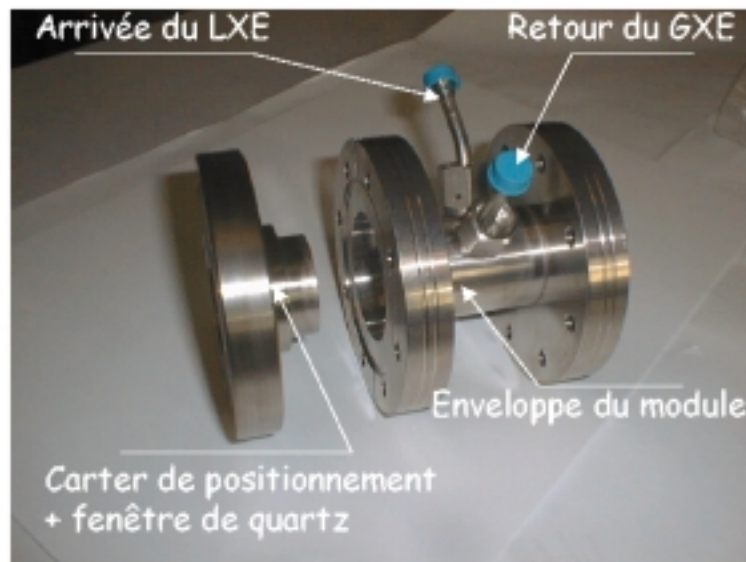
FIG. 8.40: Photo de l'extérieur de la cellule : enveloppe d'inox assurant l'arrivée et le retour du xénon ; carter de support des hublots de quartz assurant l'étanchéité entre le xénon et les PM.
