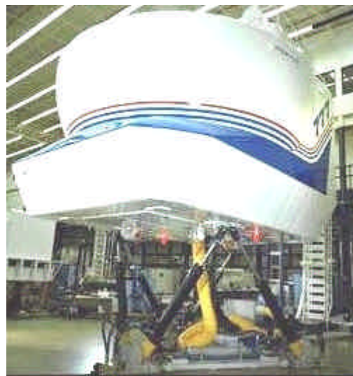
Figure I-2. Simulateur de vol (société CAE).
