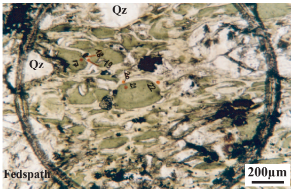
Photo 3 : Texture perlitique apparue par refroidissement d'un verre. Coeur des perles (couleur vert foncé) à compositions de chlorites et contours à compositions de céladonites (l.m. 15.1C)
