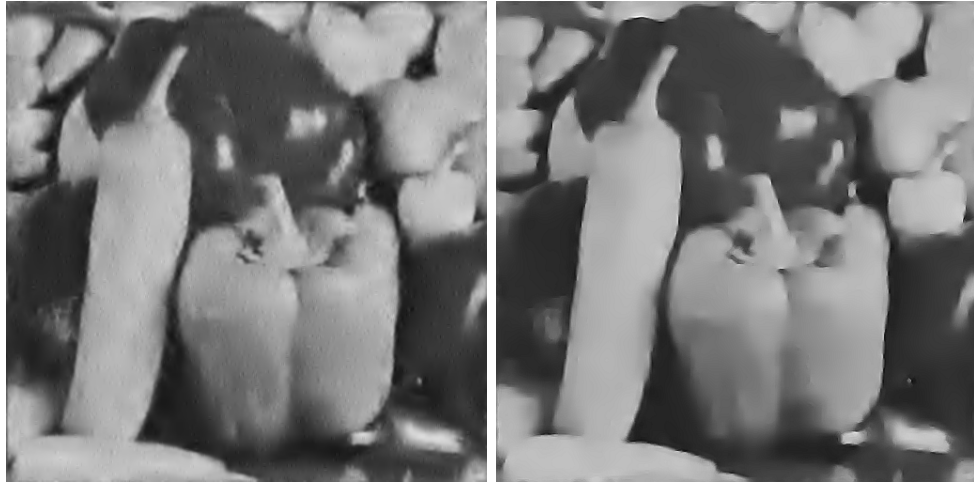
FIG. 5.76 - Résultats numériques de débruitage en utilisant le seuillage invariant par translation avec une représentation BW (PSNR 19.50) et EA (PSNR 20.18)
