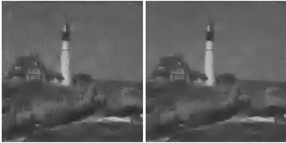
FIG. 5.78 – Résultats de débruitage en utilisant le seuillage invariant par translation avec une représentation BW (PSNR 14.91) et EA (PSNR 17.80)
