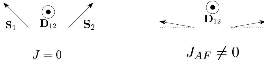
FIG. 6.1 – Type d'ordre induit par l'interaction de Dzyaloshinsky-Moriya seule, et le cas plus réaliste où elle perturbe l'ordre, ici antiferromagnétique, dû au couplage de Heisenberg.
