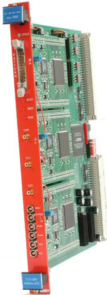
FIG. 3.12: Version finale industrielle du CAEN-V896.
