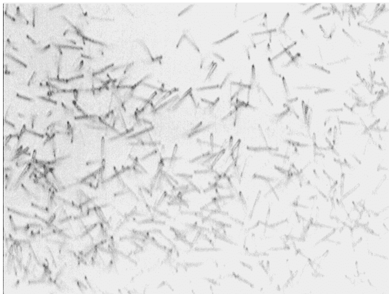
figure 18 : traces de fission mal révélées dans le mica (microscopie optique)
