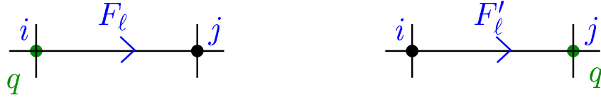
fig. 2.3: Mouvement d'une particule. La contrainte de Gauss est respectée si F'_\ell = F_\ell - q .
