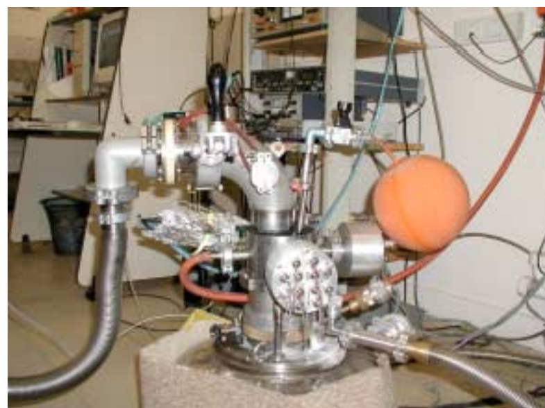
Photos numérique du cryostat à dilution
