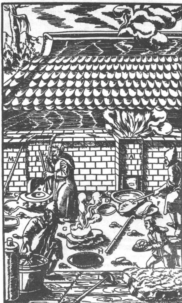
Figure I-4 Gravure sur bois représentant des bas fourneaux du Moyen Age (selon Agricola). Deux fourneaux (A, B) ; avant-creusets (bassin supérieur-C, bassin inférieur-D) ; un fondeur dégrasse la scorie (F) en utilisant un pique à crochet ; un ouvrier arrose la scorie fondue par de l'eau (G) ; un racloir (I) ; un panier en bois (H) ; un fouloir (L) ; une perche (M).
