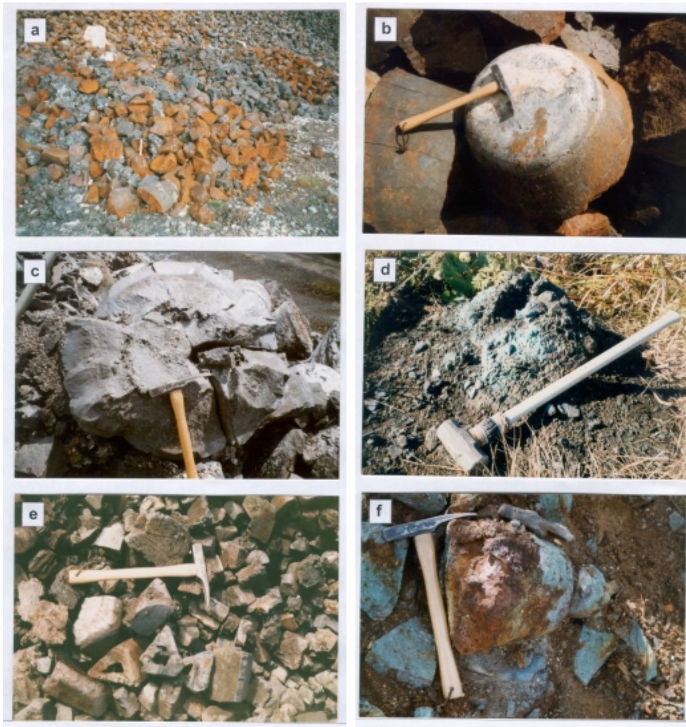
Planche photos 2 Laitiers sur les haldes à proximité de l'usine métallurgique de Příbram. a) laitiers couverts d'une couche d'oxy-hydroxydes de fer secondaires ; b) fond d'un moule composé de la matte et d'une couche de plomb natif couvert d'une phase blanche pulvérulente à composition de cérussite ( PbCO_3 ) ; c) un grand moule provenant de la technologie actuelle montrant une zonation texturale (couche du verre superficiel [pas visible, d'épaisseur de quelques millimètres maximum], couche du laitier finement cristallisé, à l'intérieur zone grossièrement cristallisée) ; d) la matte sulfurée, riche en Cu, décomposée dans les conditions humides d'un champs à côté de la halde 2, couverte d'un minéral secondaire de Cu ; e) laitier fragile de type « 56 » sous forme de gouttière provenant du traitement des batteries automobiles en utilisant la technologie de la trempe rapide (convoyeur à coulée) ; f) fond sulfuré d'un moule de laitier historique provenant du traitement des minerais, les minéraux secondaires se forment à la surface et mettent en évidence l'existence d'un processus naturel d'altération météorique.
