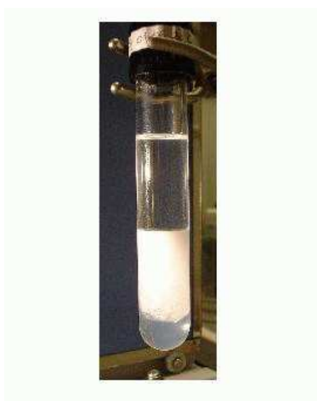
FIG. 6.6 – Allure d'un tube contenant de l'eau, du toluène et du copolymère 370/580 ainsi que du sel (200 mg de NaCl) ajouté avant agitation.
