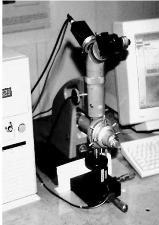
Figure 2.19 : (a) Photo du microscope LEITZ (b) Principe de fonctionnement d'un objectif Linnik.
