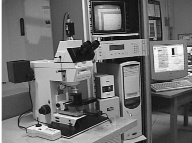
Figure 2.20 : (a) Photo du microscope LEICA DMR-X (b) Principe de fonctionnement d'un objectif Mirau.
