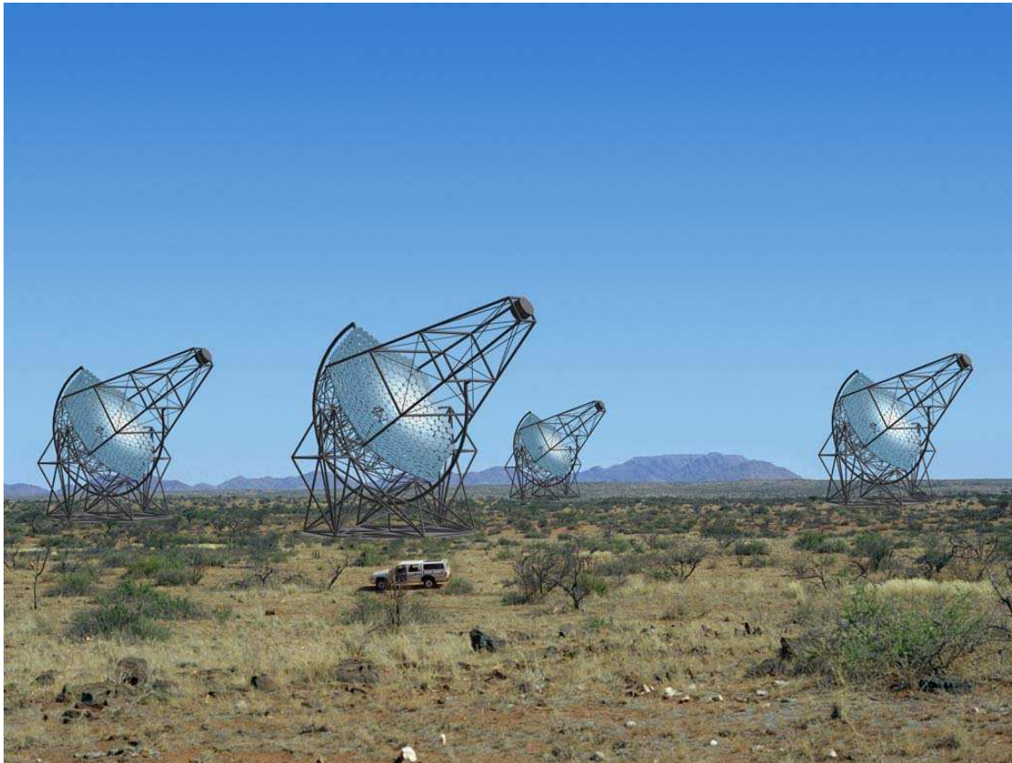
FIG. 2.5 – Photo-montage du futur système d’imageurs à effet Tcherenkov atmosphérique HESS ( http://www-hfm.mpi-hd.mpg.de/HESS/HESS.html ).
