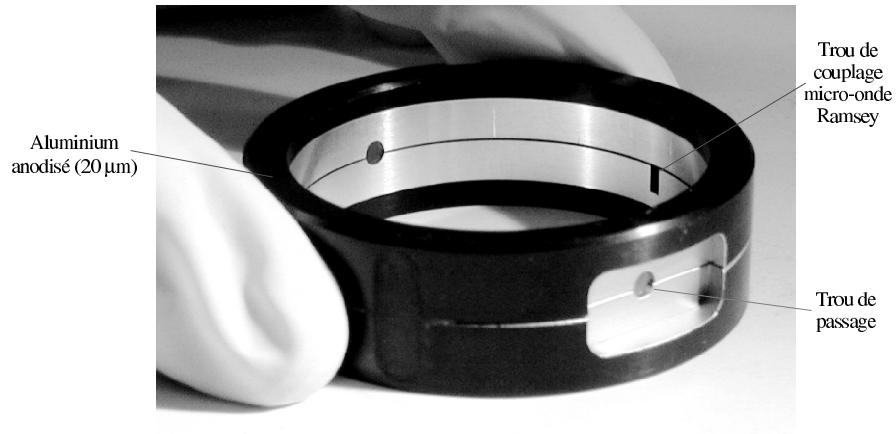
FIG. 2.15 – Cet anneau est monté autour de la cavité et permet d'obtenir un facteur de qualité de Q = 3.2 \cdot 10^8 . Sur la photo, on voit les trous laissant passer le jet atomique, et aussi le trou sur le côté qui permet d'effectuer les impulsions de Ramsey à l'intérieur de la structure "cavité+anneau".
