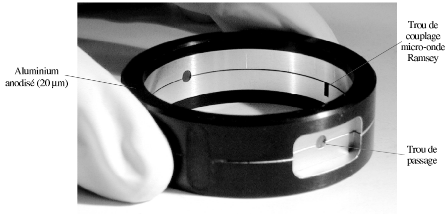
FIG. 2.15 – Cet anneau est monté autour de la cavité et permet d'obtenir un facteur de qualité de Q = 3.2 \cdot 10^8 . Sur la photo, on voit les trous laissant passer le jet atomique, et aussi le trou sur le côté qui permet d'effectuer les impulsions de Ramsey à l'intérieur de la structure "cavité+anneau".
