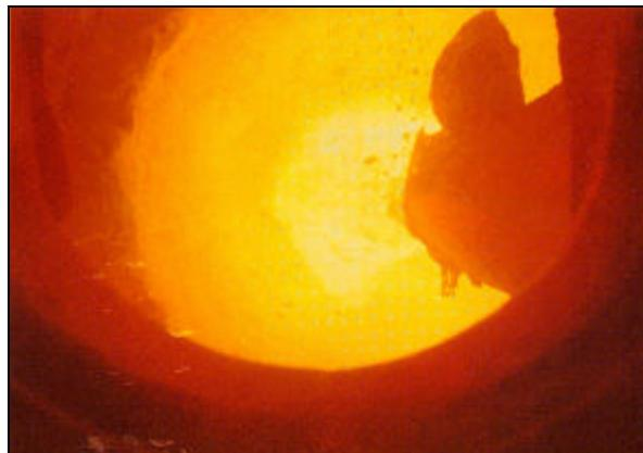
*La haute température (2000°C) atteinte dans les fours de cimenteries, permet la destruction totale des sous-produits industriels qui y sont valorisés énergétiquement.*
