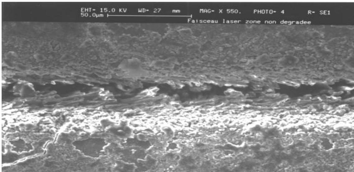
Photo 5 – Photo MEB du sillon d'ablation laser (20µm de largeur) laissé sur un échantillon dans la zone saine (G=550.x)
