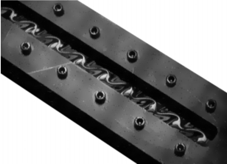
FIG. 8.4 – Compression bi-axiale d'une bande de film élastique obtenue par la dilation d'un cadre-mâchoire métallique, © IRPHE.
