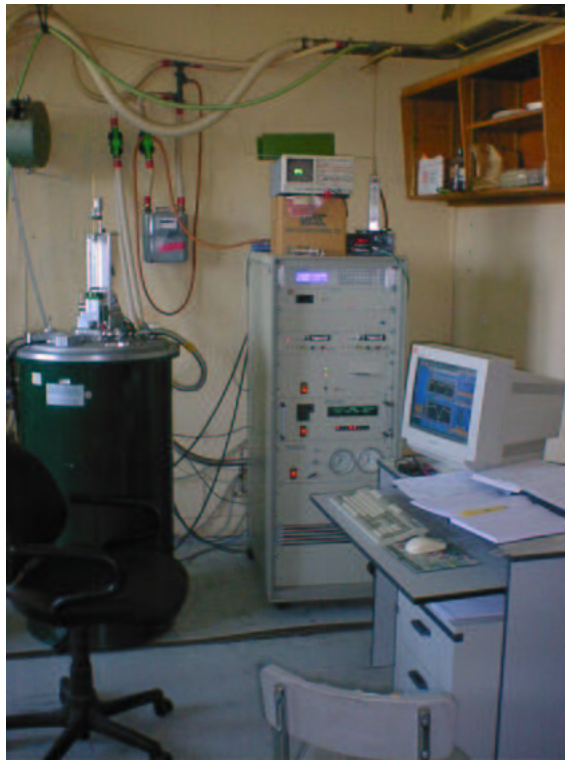
FIG. 1.1 – Photographie du magnétomètre à SQUID Cryogenic Ltd S600 du laboratoire. On distingue nettement à gauche le cryostat, au centre le rack contenant l'électronique de commande et à droite l'ordinateur permettant de piloter l'ensemble de l'instrument.
