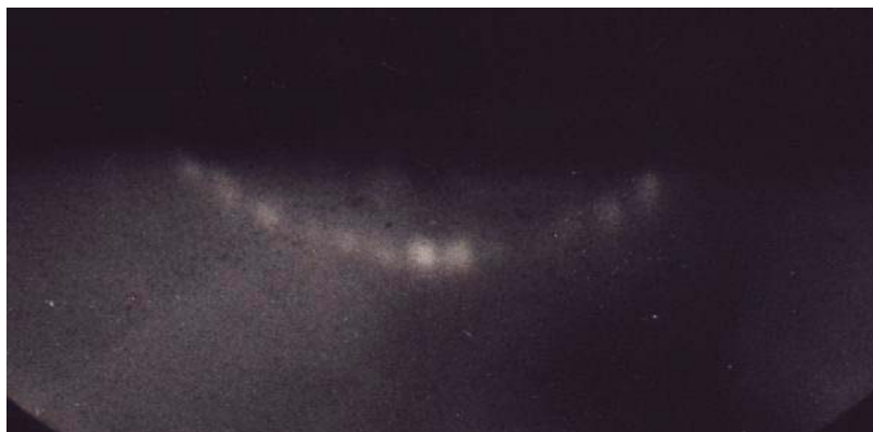
Figure III.5.1.a : diagramme RHEED d'une surface désoxydée de Si(111)
