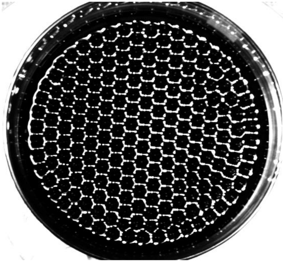
FIG. 2.1: Le réseau hexagonal de pics; vue de dessus. La distance entre pics est de l'ordre du centimètre, ainsi que la hauteur des pics.
