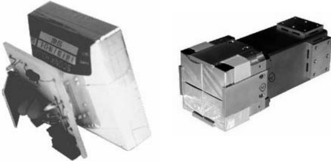
Figure 2.10 : A gauche : Détecteur CsI ``single`` muni de sa photodiode. A droite : Détecteur CsI ``quattro`` constitué de quatre cristaux CsI indépendants. Ce type de CsI permet de traiter des événements où deux particules touchent le module sur lequel ces cristaux sont montés. Ils ont été utilisés pour la première fois lors de l'expérience E317a.
