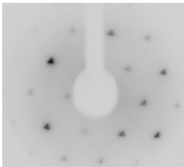
Figure III-2-4 : Diagramme de diffraction d'une surface de mica clivée à l'air, composé de taches triangulaires
