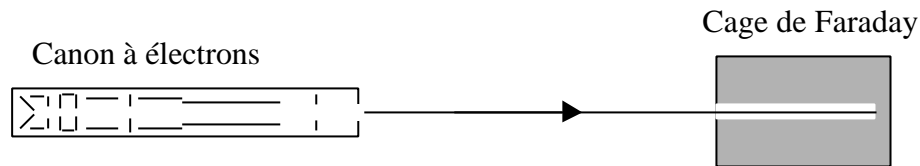
Figure II-2-2 : Mesure du courant primaire avec une cage de Faraday.
