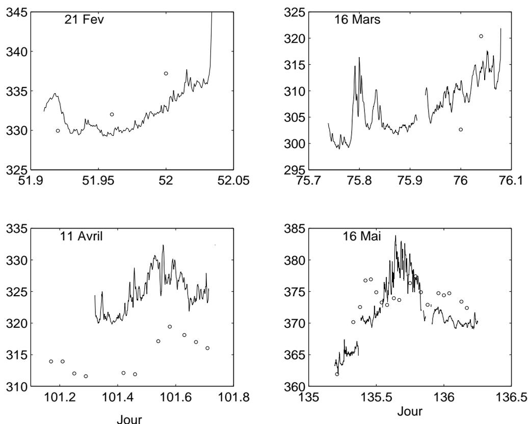
**Figure III.16:** Comparaison entre les mesures de pCO<sub>2</sub> à température in situ (en  $\mu\text{atm}$ ) obtenues depuis le bateau (trait continu) et à la bouée Carbone (ronds) sur le site Dyfamed, pendant quelques jours de l'année 1999.
