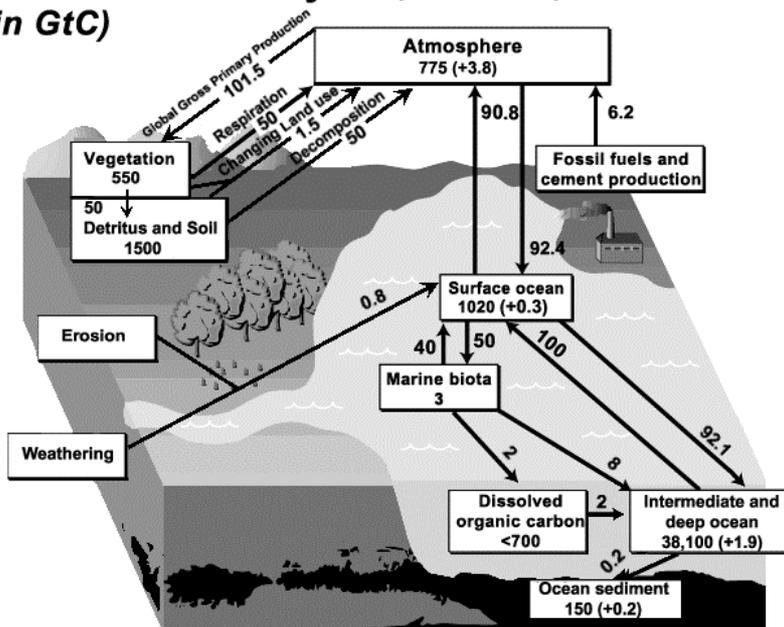
Figure I.4: Cycle du carbone de 1992 à 1997 (d'après <http://cdiac.esd.ornl.gov/>). Principaux réservoirs (chiffres en Gt C figurant dans les rectangles) et flux de carbone exprimés en Gt C an<sup>-1</sup>, représentés par les flèches reliant les différents réservoirs. Les chiffres entre parenthèses indiquent le taux d'augmentation moyen annuel.
