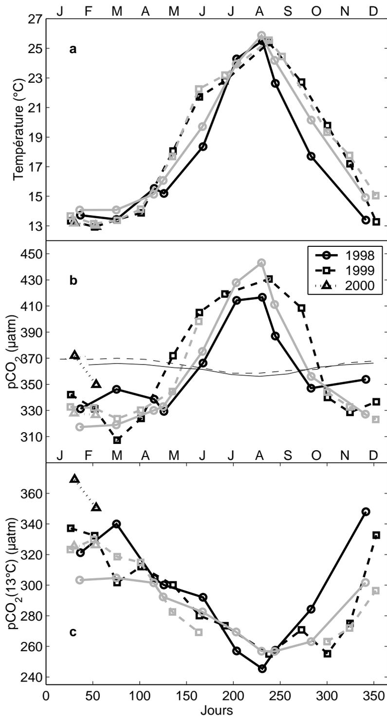
Figure III.28: Cycles annuels de (a) la température in situ, (b) pCO<sub>2</sub> à température in situ et (c) pCO<sub>2</sub>(13°C), issus des valeurs moyennes mesurées mensuellement dans la zone côtière (en gris) et dans la zone centrale (en noir) du bassin Liguro-Provençal. Les moyennes de température de juillet, août et septembre 1999, pour la zone côtière proviennent des mesures acquises au thermosalinographe, sans acquisition en continu de pCO<sub>2</sub>.
