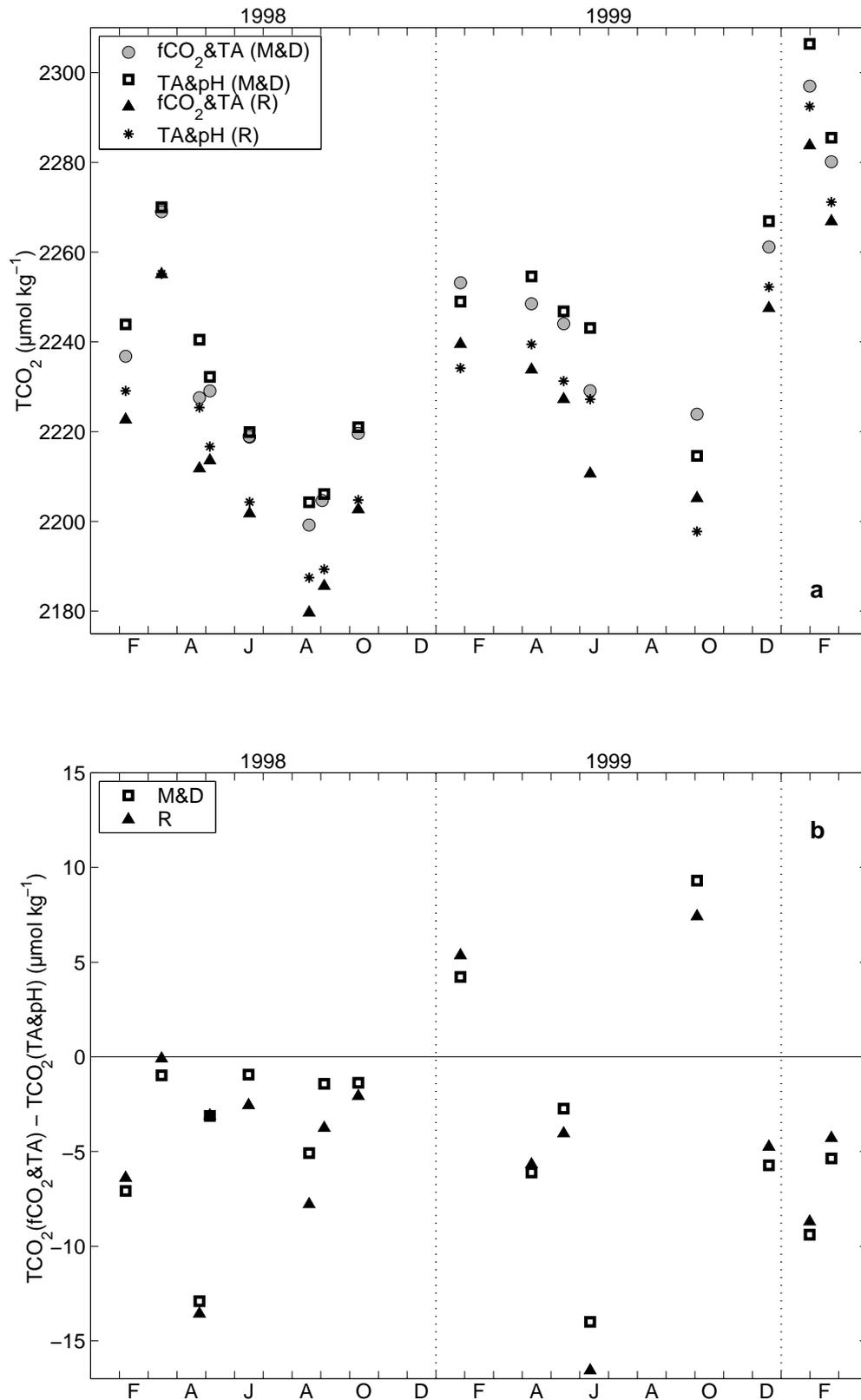
Figure A1.2: (a) Série temporelle de  $\text{TCO}_2$  calculé à partir des couples  $\text{fCO}_2$ -TA et pH-TA, en utilisant les constantes de M&D ou de R, (b) Ecart entre  $\text{TCO}_2$  déduit du couple  $\text{fCO}_2$ -TA et  $\text{TCO}_2$  déduit du couple pH-TA, calculé en utilisant les constantes de M&D ou de R.
