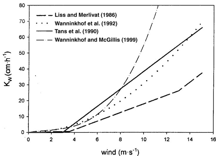
Figure VI.3: Différentes relations du coefficient de transfert du CO<sub>2</sub> à l'interface air-mer pour un nombre de Schmidt de 600, en fonction de la vitesse du vent mesuré à une hauteur de 10 m au-dessus de la mer (d'après Perez et al. (2001)). Celles de L&M, de Wa92 et de Wa99 sont utilisées dans ce travail de thèse.
