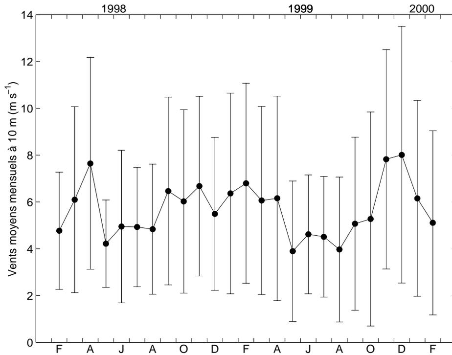
Figure VI.8: Moyennes mensuelles de la vitesse du vent à 10 m, et écarts-types sur les mesures. Les vitesses de vent pour la période de février 1998 à février 1999, sont issues des données tri-horaires du Cap-Corse. De mars 1999 à février 2000, les vitesses de vent sont celles mesurées directement à la bouée Météo.
