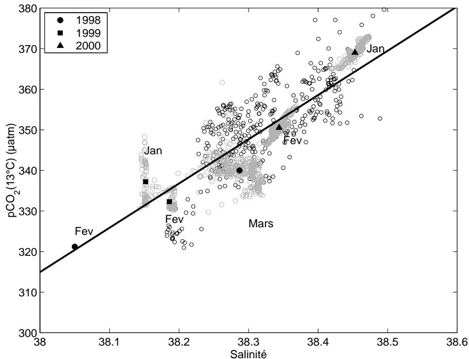
Figure III.22: Droite de régression pCO<sub>2</sub>(13°C)-salinité de surface, obtenue à partir des moyennes mensuelles (cercles, carrés et triangles pleins noirs) des mesures bateau (cercles gris) pour les mois d'hiver au site Dyfamed. Les cercles noirs sont les données mesurées à la bouée Carbone en février 1999.
