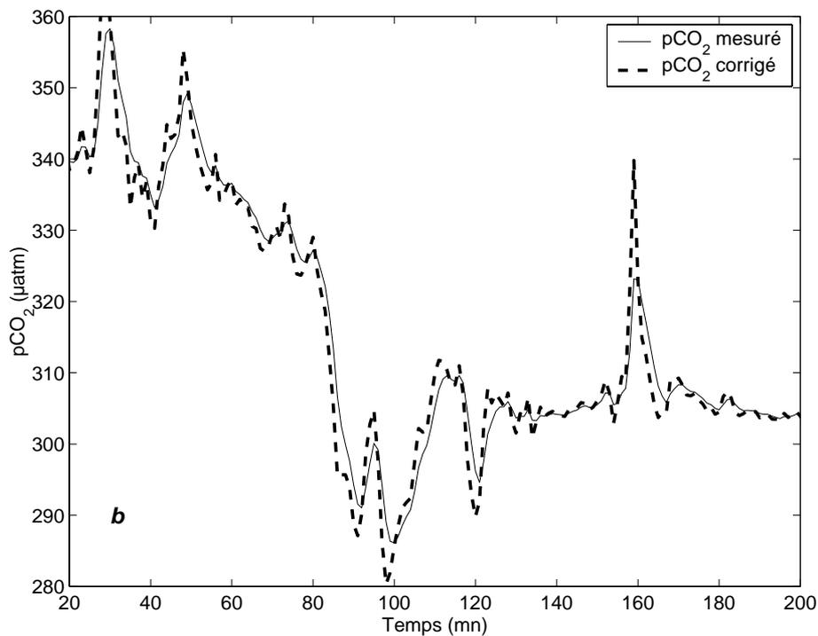
Figure A2.3b: Tracé des données de pCO<sub>2</sub> mesurées en mars 1998 corrigées ou non de la constante de temps d'équilibrage de 2 mn 05 s, dans le cas de notre montage.
