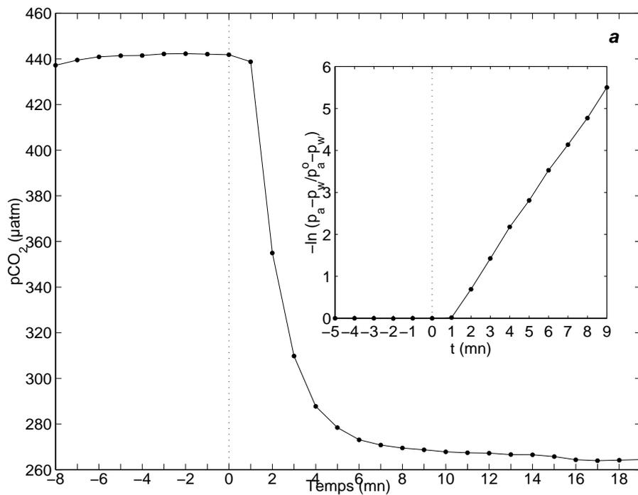
Figure A2.3a: Résultats de l'expérience de détermination de la constante de temps d'équilibrage de pCO<sub>2</sub> dans la cellule. L'encart montre le tracé de  $-\ln((p_a - p_w) / (p_a^0 - p_w))$  en fonction du temps, dont la pente nous donne la constante de temps.
