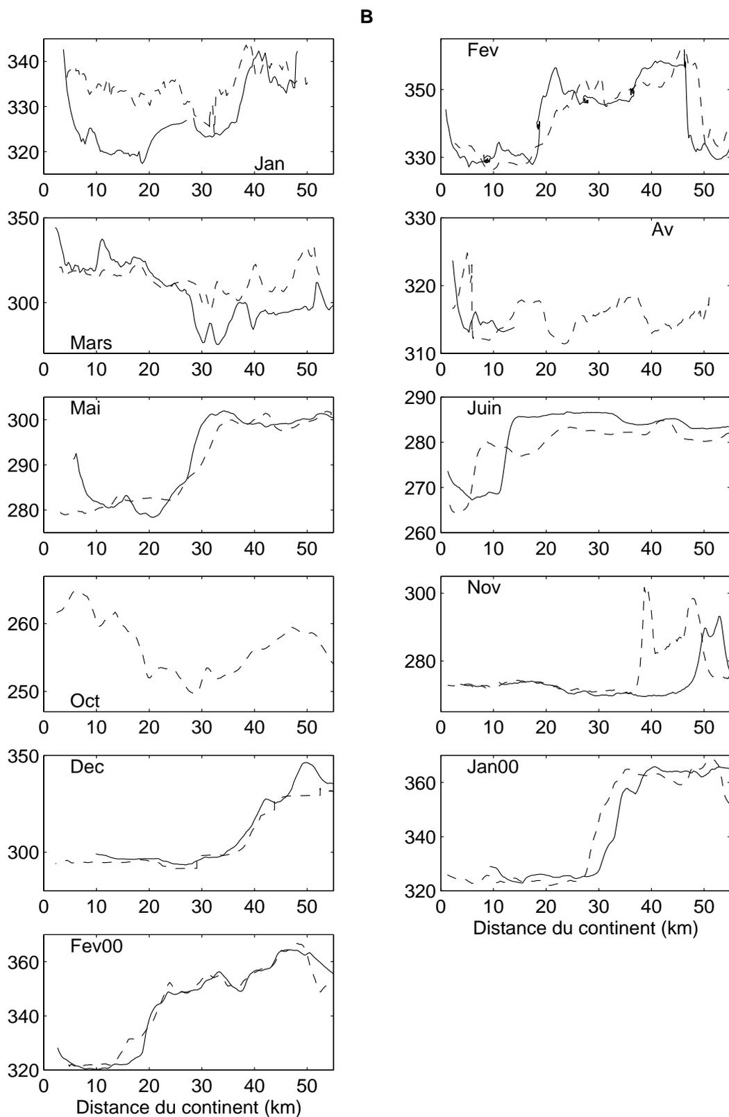
**Figure III.12b:** Distribution horizontale de  $p\text{CO}_2(13^\circ\text{C})$  (en  $\mu\text{atm}$ ), obtenue mensuellement de janvier 1999 à février 2000, sur le trajet aller (trait continu) et retour (tirets), le long de la radiale Nice-site Dyfamed.
