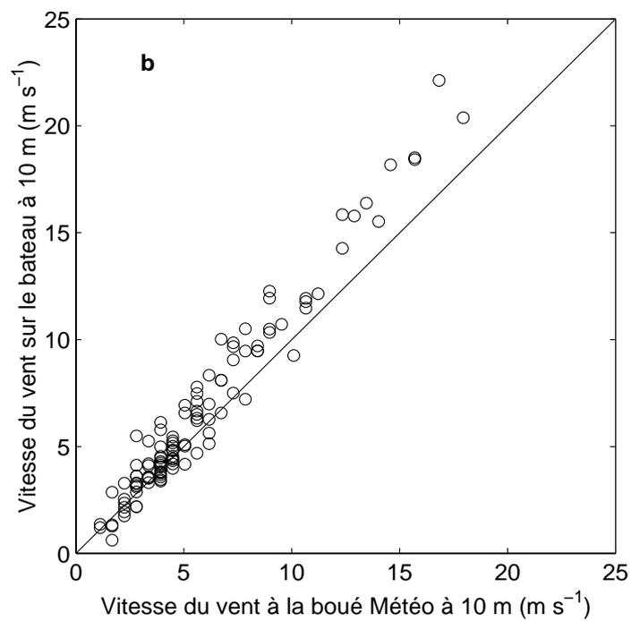
Figure A4.2: (a) Vitesse horaire du vent mesuré à la bouée Carbone, en fonction de la vitesse horaire à la bouée Météo (b) Vitesse du vent mesurée sur le bateau et interpolée toutes les heures en fonction de la vitesse mesurée à la bouée Météo.
