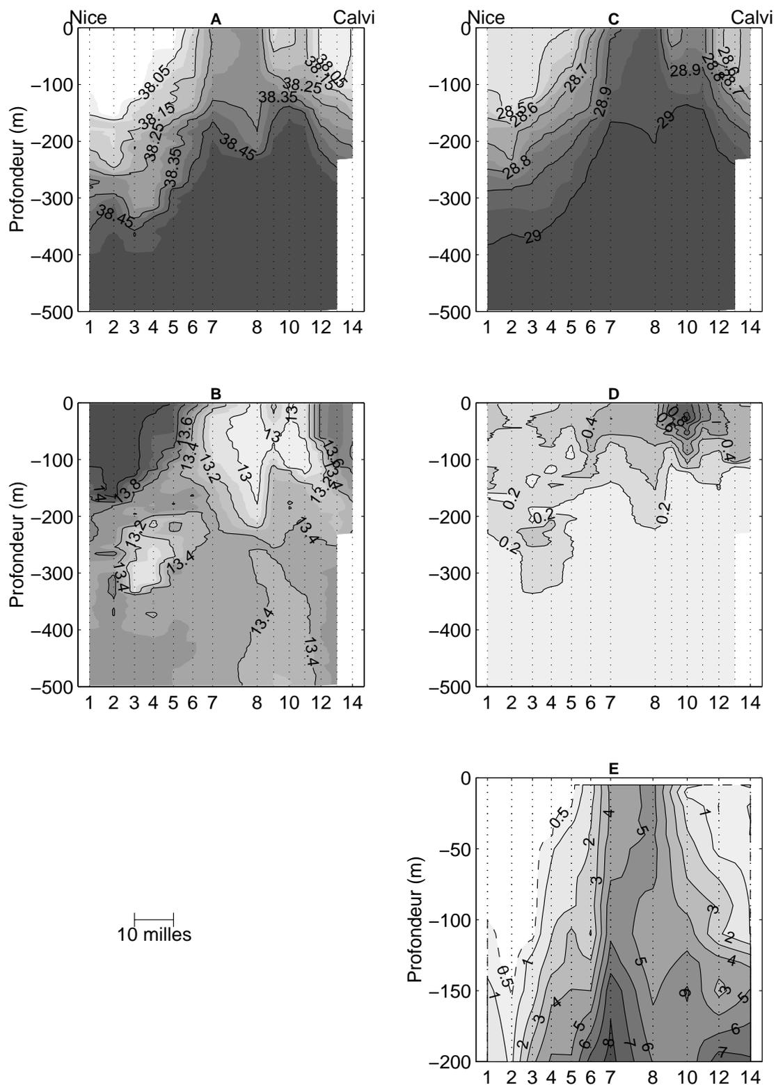
Figure III.2: Coupes verticales de **A** la salinité, **B** la température ( $^{\circ}\text{C}$ ), **C** la densité ( $\text{kg m}^{-3}$ ), **D** la teneur en chlorophylle *a* ( $\text{mg m}^{-3}$ ), entre 0 et 500 m de profondeur et **E** la teneur en nitrates ( $\mu\text{mol l}^{-1}$ ) entre 0 et 200 m de profondeur; le long de la radiale Nice-Calvi, du 5 au 6 février 1998.
