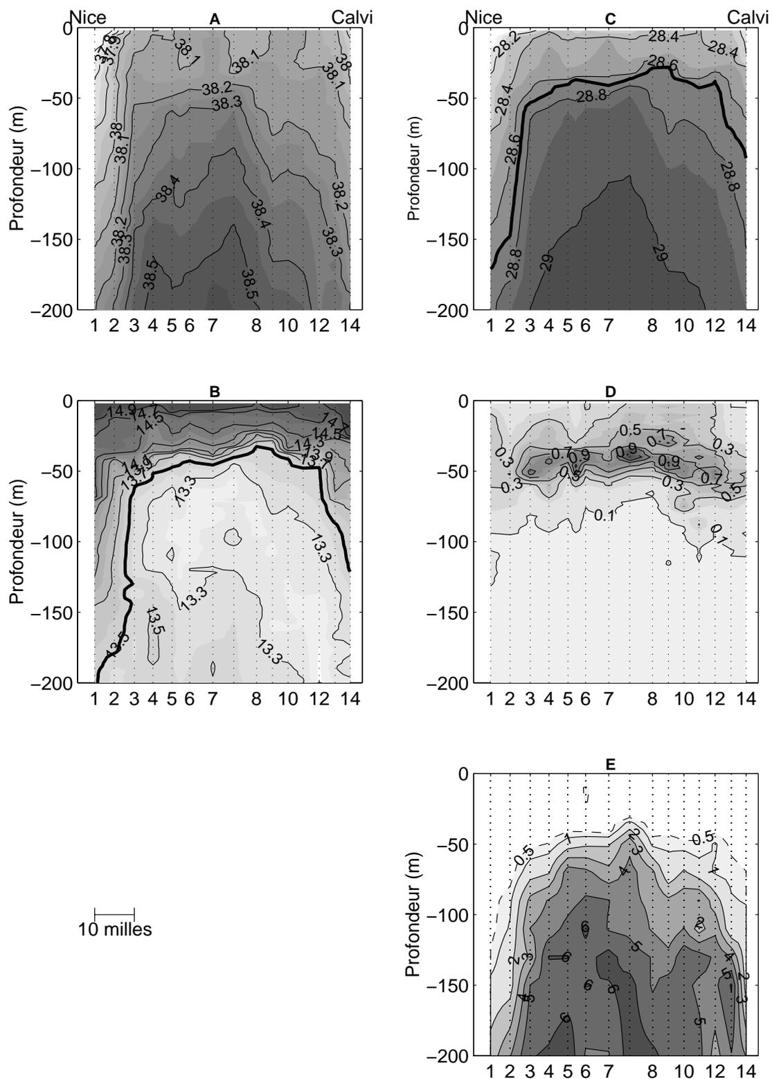
Figure III.5: Coupes verticales de A la salinité, B la température ( $^{\circ}\text{C}$ ), C la densité ( $\text{kg m}^{-3}$ ), D la teneur en chlorophylle *a* ( $\text{mg m}^{-3}$ ), et E la teneur en nitrates ( $\mu\text{mol l}^{-1}$ ) entre 0 et 200 m de profondeur; le long de la radiale Nice-Calvi, du 5 au 7 mai 1998.
