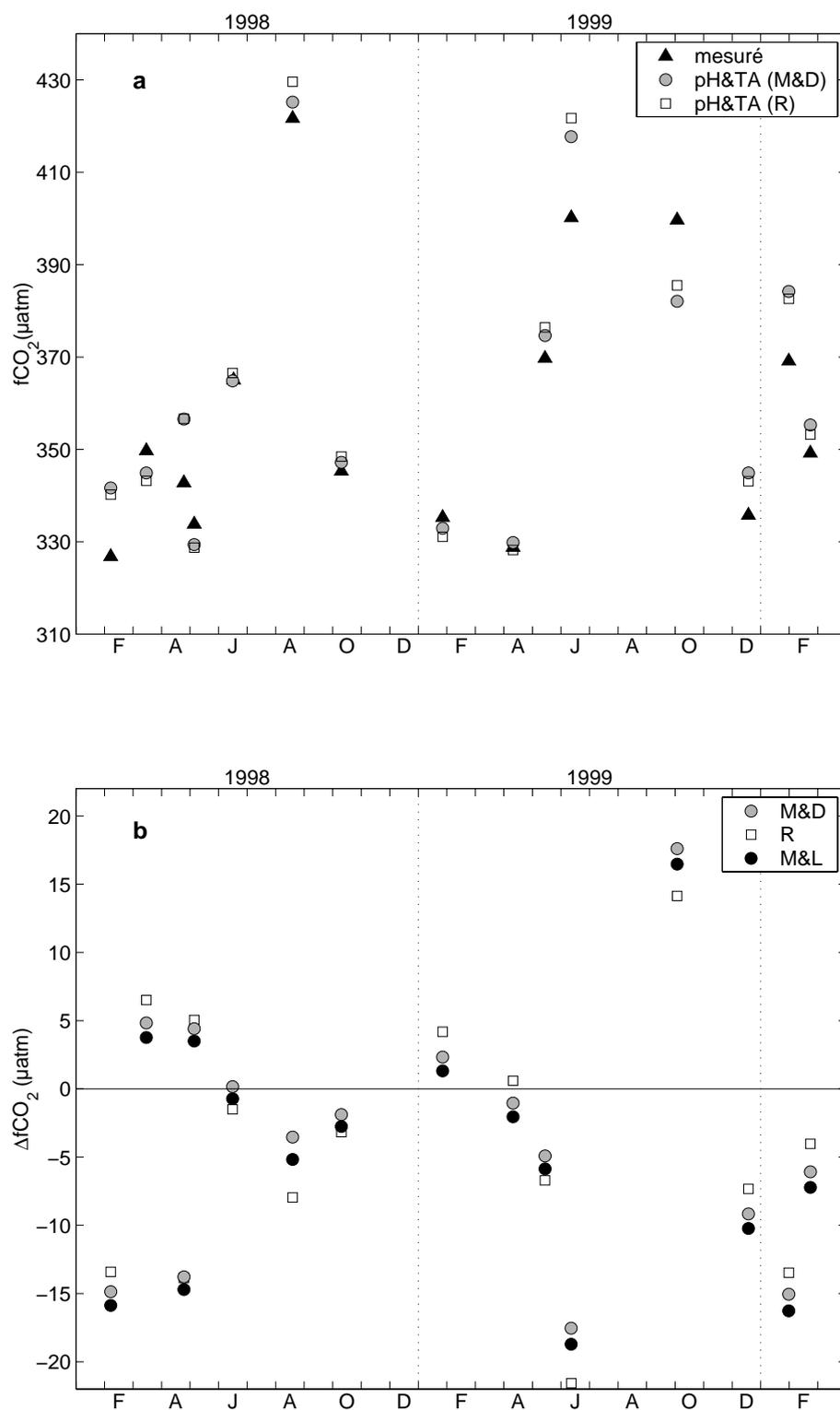
Figure A1.1: (a) Série temporelle de  $f\text{CO}_2$  mesuré et de  $f\text{CO}_2$  calculé à partir du couple pH-TA en utilisant soit les constantes de M&D, soit les constantes de R, ajustées sur l'échelle  $H_T$ . (b) Ecart de  $f\text{CO}_2$  calculé à partir des constantes de M&D, de R ou de M&L, par rapport à  $f\text{CO}_2$  mesuré ( $\Delta f\text{CO}_2 = f\text{CO}_2 \text{ mesuré} - f\text{CO}_2 \text{ calculé}$ ).
