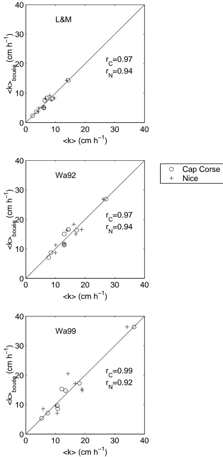
Figure A3.3: Moyennes mensuelles du coefficient de transfert, calculées à partir des vitesses de vent tri-horaires du Cap Corse et horaires de Nice, ajustées à la bouée Météo à partir des droites de régression données sur la figure A3.2a et b respectivement.
