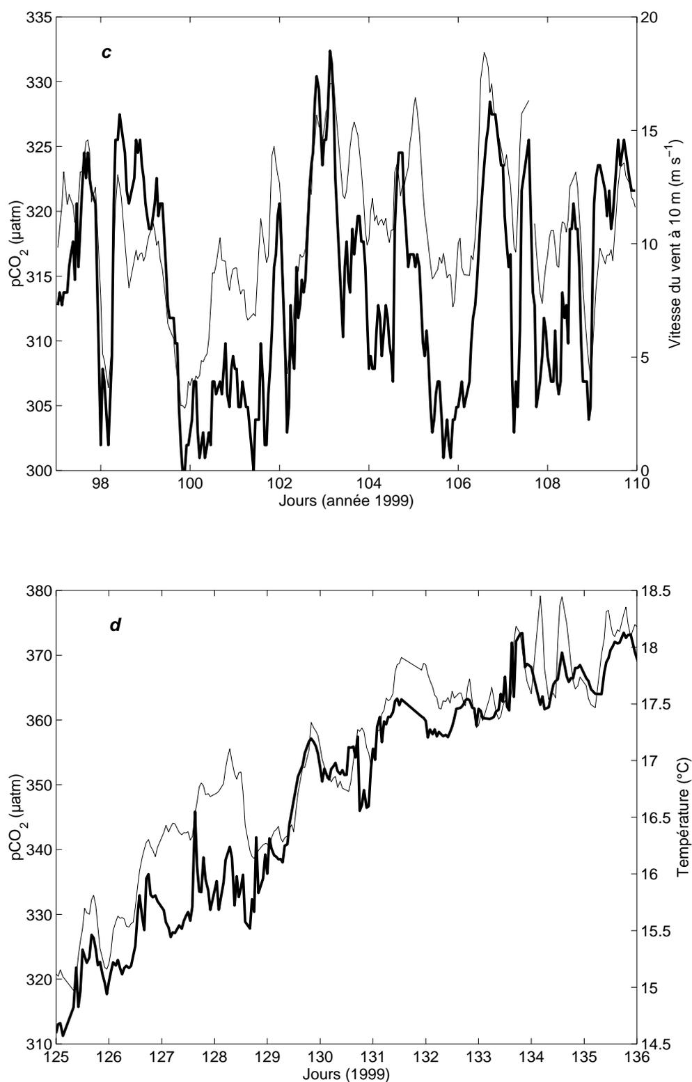
**Figure III.18:** (c) Distribution de pCO<sub>2</sub> à température in situ (trait fin) et de la vitesse du vent (trait épais) mesurés du 7 au 20 avril 1999, sur le site Dyfamed à la bouée Carbone. (d) Distribution de pCO<sub>2</sub> à température in situ (trait fin) et de la température de surface (trait épais), mesurés du 5 au 15 mai 1999 à la bouée Carbone.
