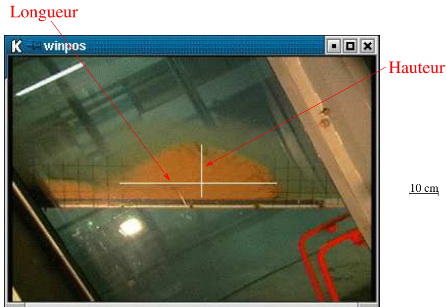
FIG. 5.6: Mesure de la hauteur et de la longueur d'une bouffée directement sur l'image par tracé de traits indiquant ces deux grandeurs. Cette image est celle d'une bouffée de sciure s'écoulant sur une pente de 32^\circ .
