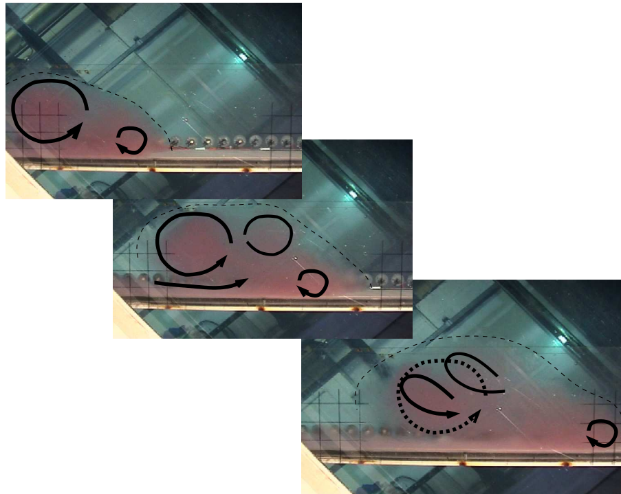
FIG. 5.34: Exemple de bouffée d'eau salée s'écoulant sur une pente de 32^\circ . Quelques particules ont été ajoutées à la bouffée d'eau salée pour permettre de mieux visualiser la structure interne de la bouffée. Les trois images successives correspondent à trois clichés successifs de la même bouffée au cours de son écoulement. Il est de nouveau possible de voir la présence des deux vortex et du courant d'eau claire en dessous de la bouffée. On peut aussi noter la présence de phénomènes temporaires supplémentaires tel que le détachement d'une partie de fluide depuis la partie avant qui migre sur le haut de la bouffée pour venir se mélanger à terme au vortex arrière en écrasant momentanément ce dernier.
