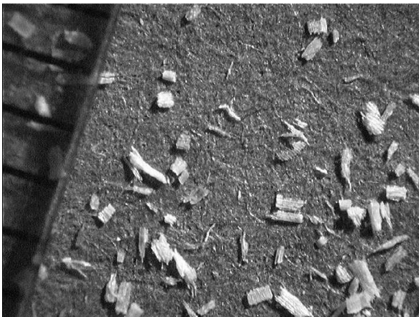
FIG. 5.3: Échantillon de particules de sciure vu au microscope.
