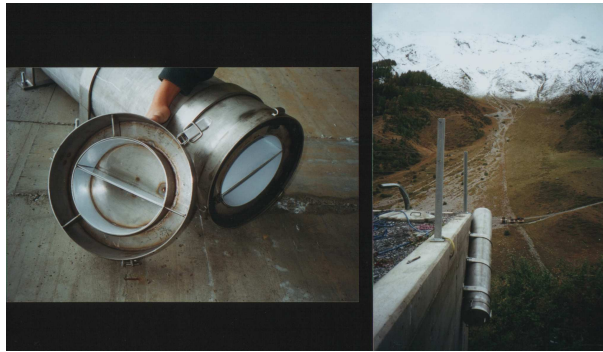
FIG. C.2: Photographie du dispositif en place sur le bunker et du mécanisme du fond amovible.
