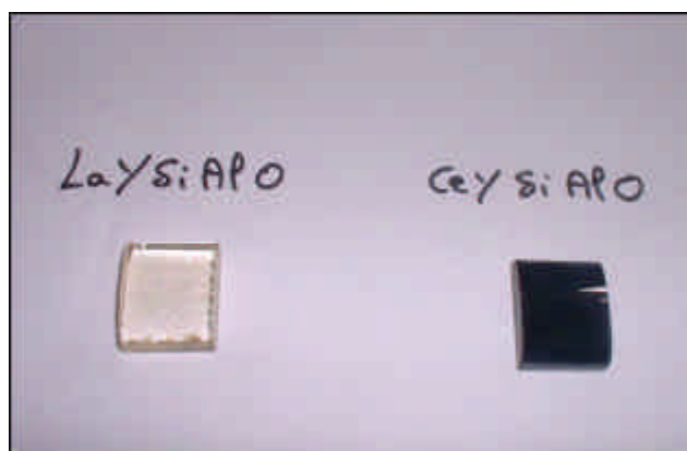
Figure III-1 : Photo des verres LaYSiAlO et CeYSiAlO après recuit et première taille grossière
