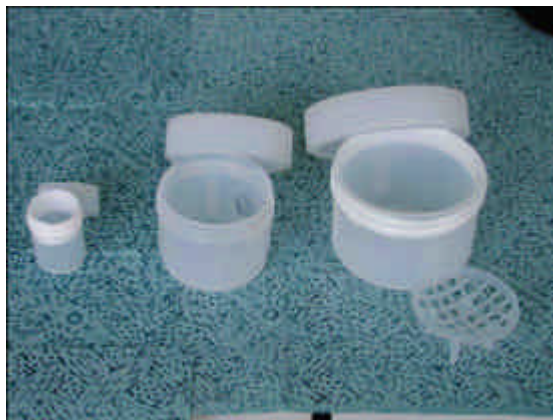
Figure II-4 : Conteneurs et panier en en Téflon utilisés pour les lixiviations statiques
