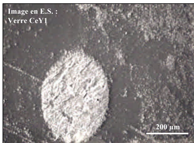
Figure IV-9 : Image en électrons secondaires d'une région de la surface du verre CeY1 altéré 3 mois en dynamique.
