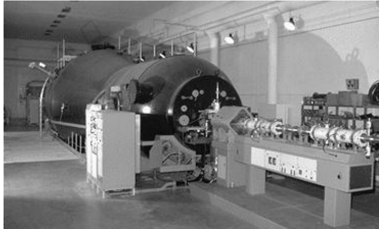
Figure 2.14 : Equipement de test sous radiation du Tandem Van der Graff
