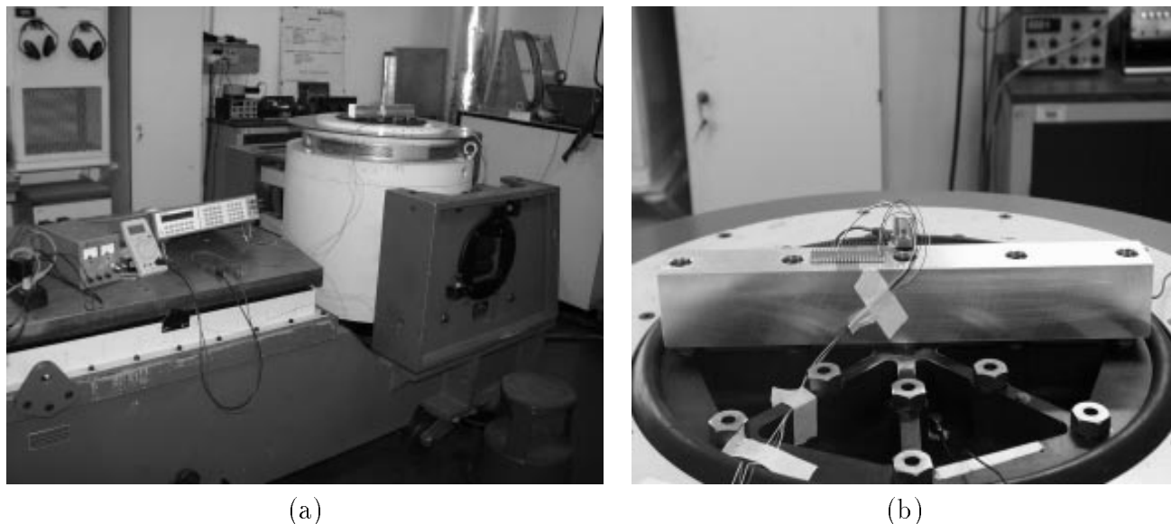
Figure 5.12: a) Vue d'ensemble du pot vibrant. b) Vue rapprochée de la barre d'aluminium sur laquelle est collée la puce et l'accéléromètre.
