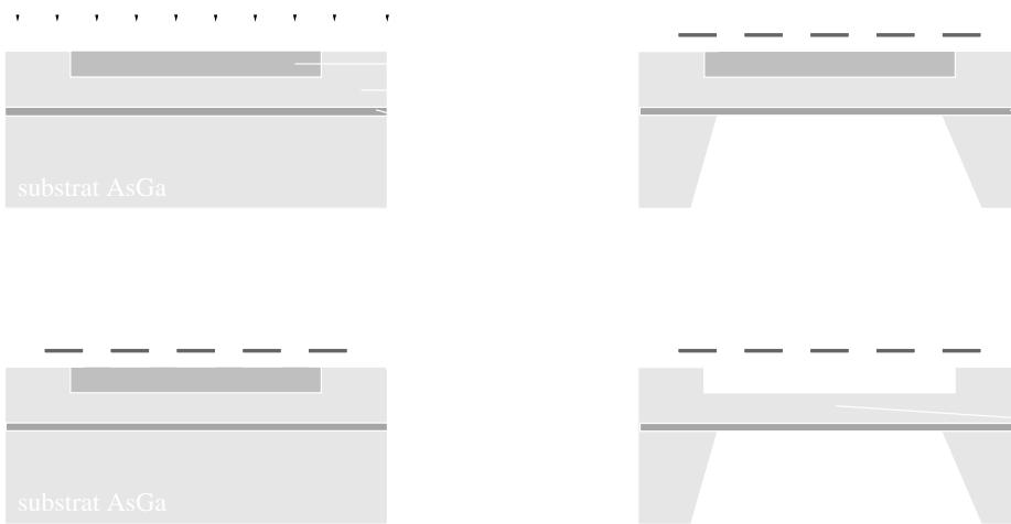
Fig. 2 - Micro-usinage du substrat par la face avant et par la face arrière.
