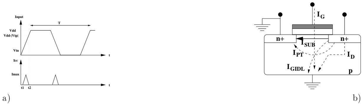
Figure D.3: Courant de court-circuit
