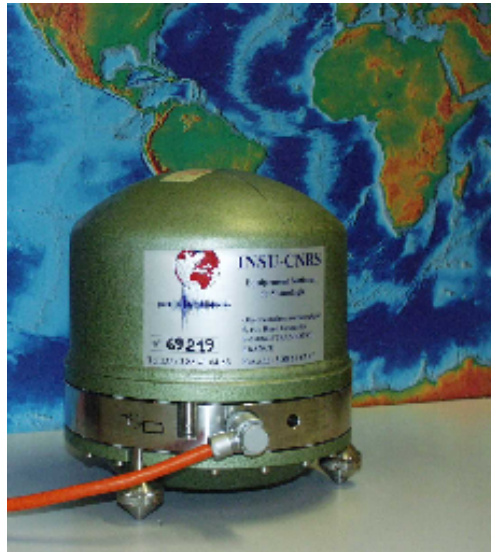
FIG. 1.13: Sismomètre Wielandt-Streckeisen STS-2 du type installé en Corne de l'Afrique.
