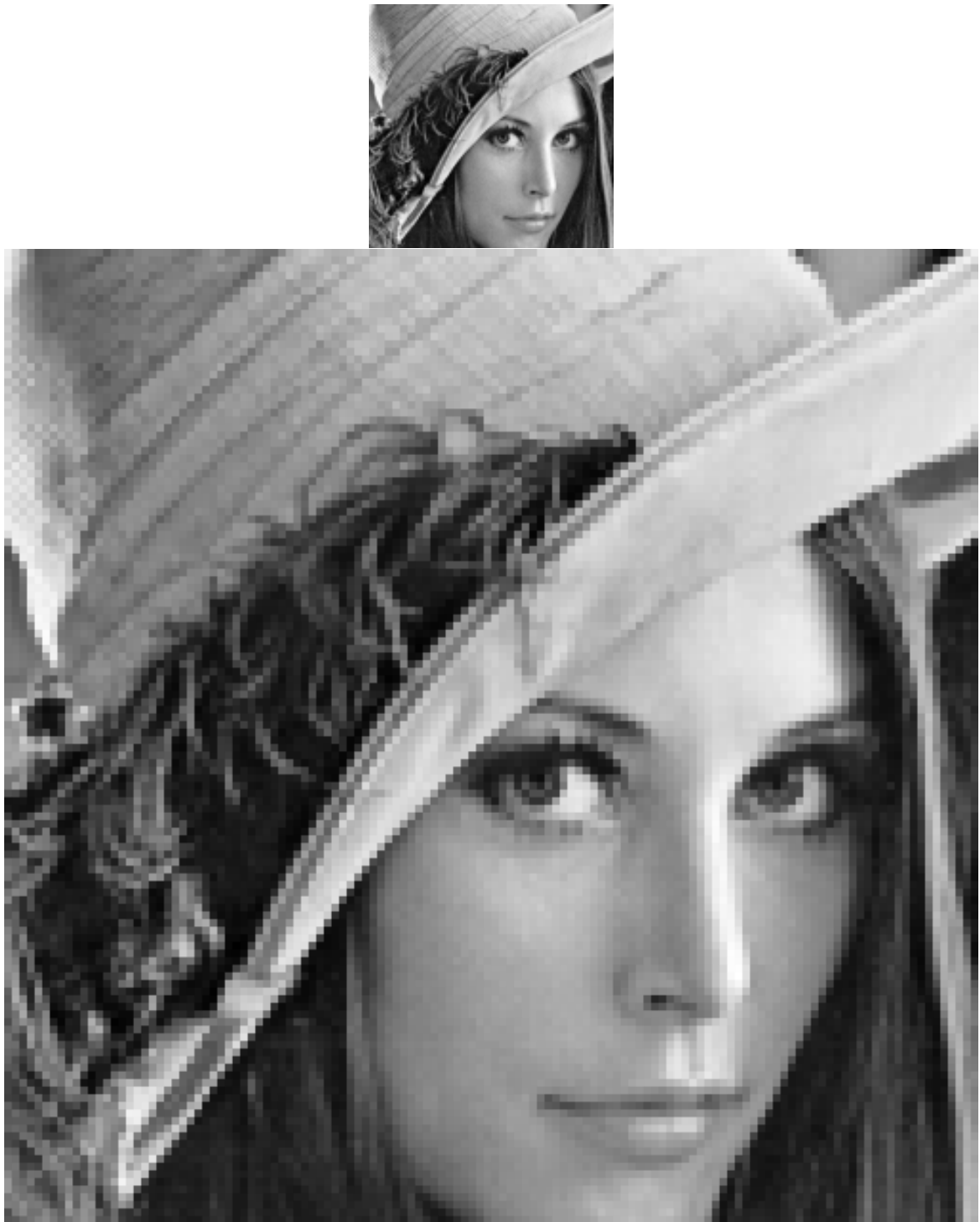
FIG. 11.9 – En haut : Image de Lena. En bas : Agrandissement par duplication de taille 4.
