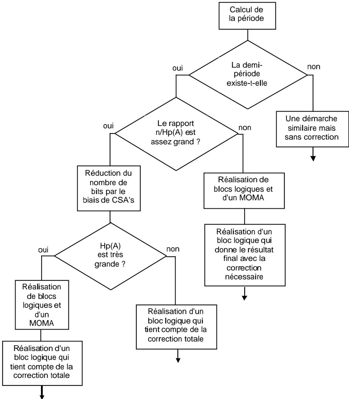
Figure 2.9. L'algorithme de réalisation d'un générateur de résidus
