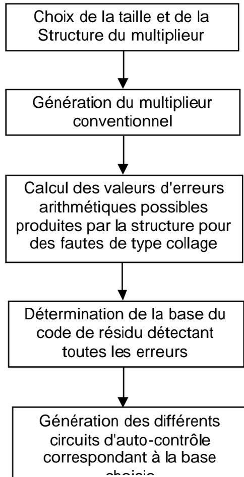
Figure 4.14. Le flot de données de nos outils de génération de multiplieurs auto-contrôlables
