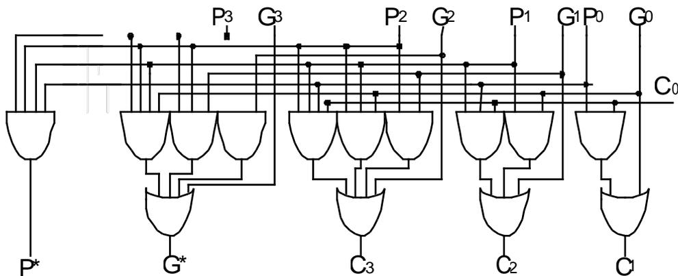
Figure 3.5. Une CLU 4 bits élément d'un CLA cascadié
