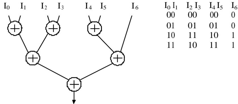
Figure 1.3. Vecteurs de test pour un arbre XOR à sept entrées
