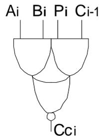
Figure 5.7. Génération de retenues d'auto-contrôle à partir des retenues normales
