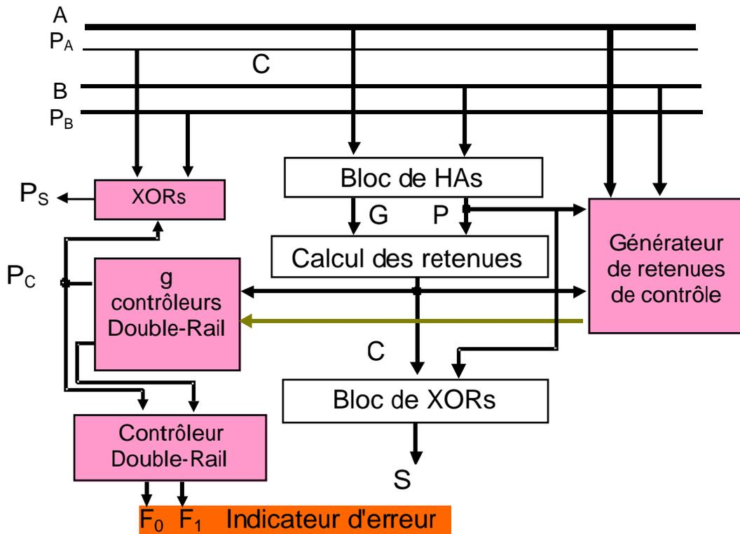
Figure 5.8. Additionneur rapide sûr en présence de fautes avec plusieurs groupes de parité
