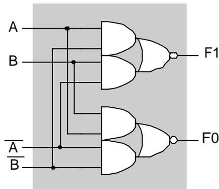
Figure 1.4. Cellule de base du contrôleur double-rail
