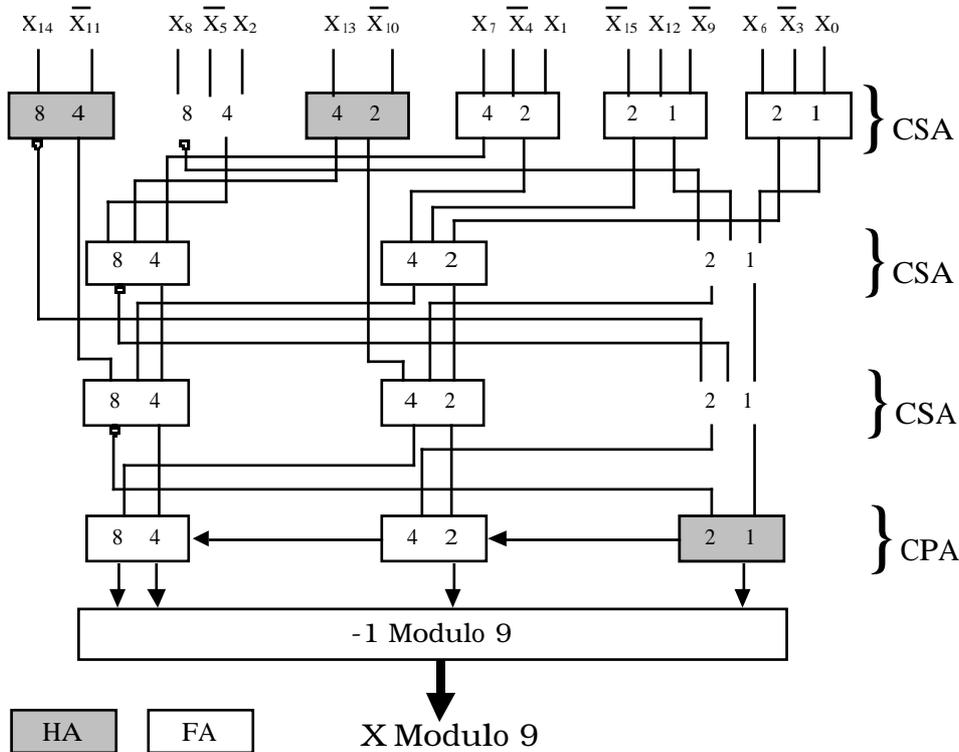
Figure 2.6. Générateur modulo 9 à 16 bits
