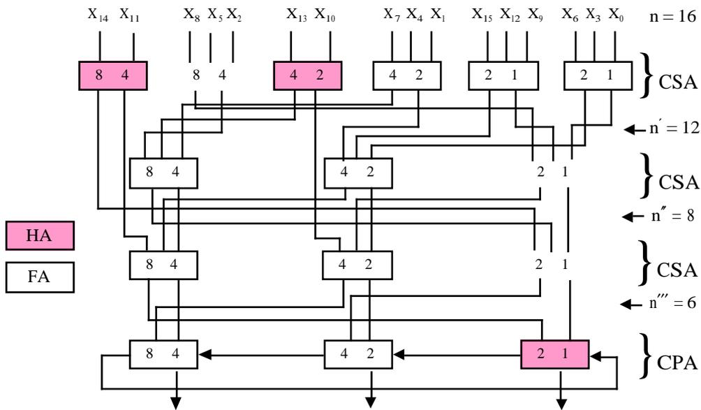
Figure 2.5. Générateur modulo 7 à 16 bits
