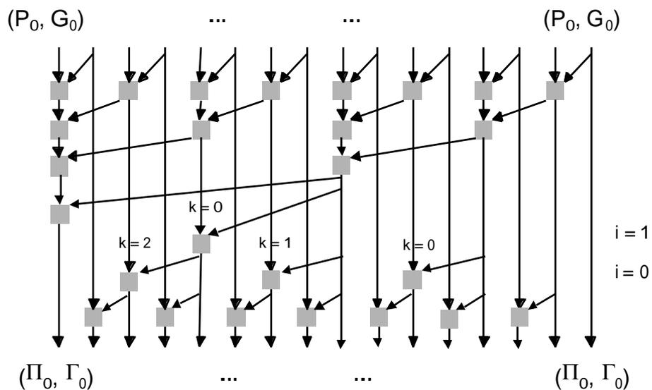
Figure 3.11. Structure de Brent et Kung pour 16 bits
