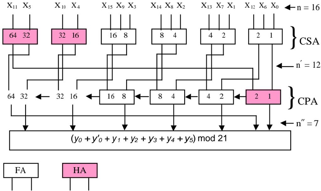
Figure 2.4. Générateur modulo 21 à 16 bits.
