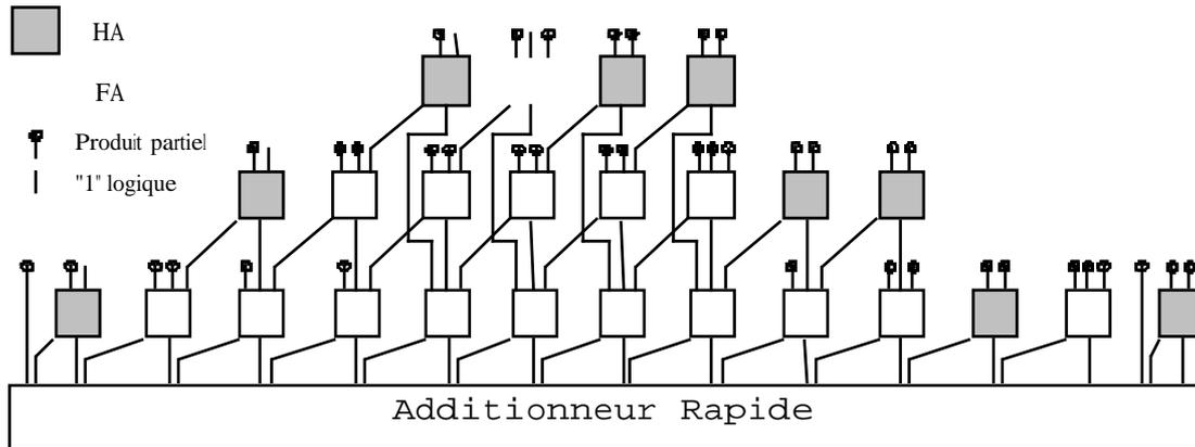
Figure 4.13. Un multiplieur de Booth 8x8 utilisant un arbre de Wallace
