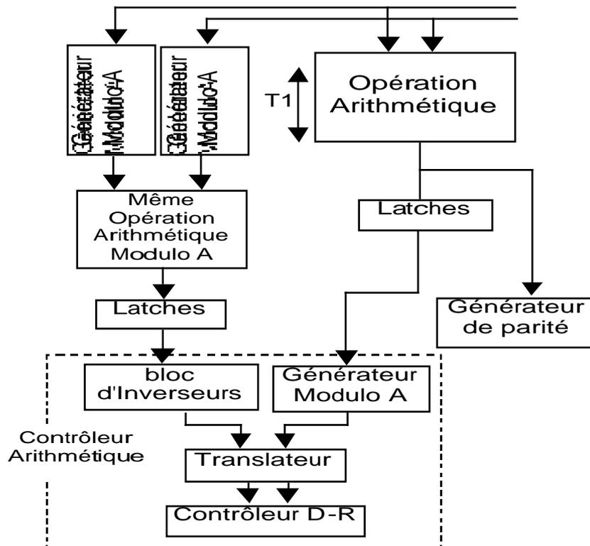
Figure 2.1. Structure générale d'un circuit auto-contrôlable basé sur le code résidu
