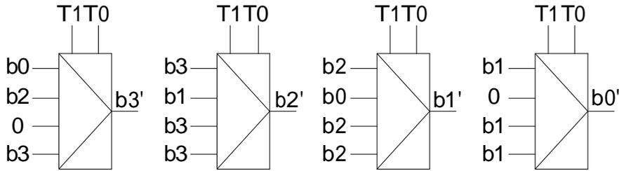
Figure 5.2. Un registre à décalage d'une position à 4 bits
