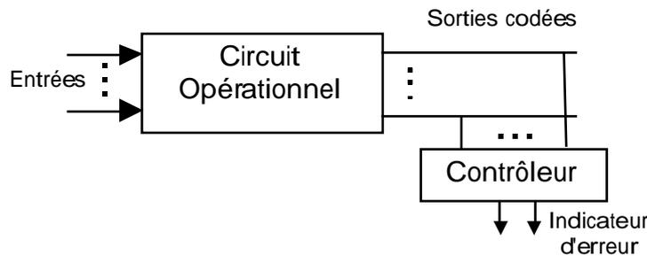
Figure 1.1. La structure générale d'un circuit auto-contrôlable
