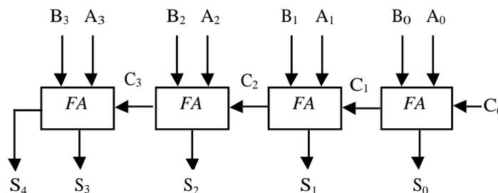
Figure 3.1. Additionneur séquentiel de 4 bits
