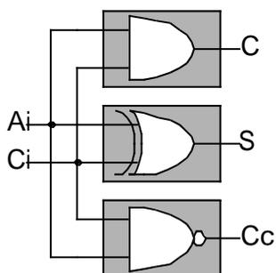
Figure 5.4. Une cellule de HA avec retenue redondante
