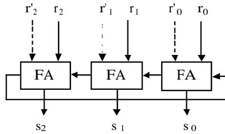
Figure 2.2. Un additionneur modulo 7 de deux résidus modulo 7
