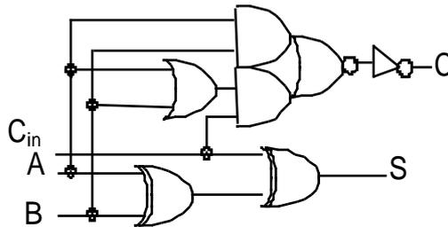
Figure 3.2. Une cellule de FA sans partage de portes logiques entre les sorties
