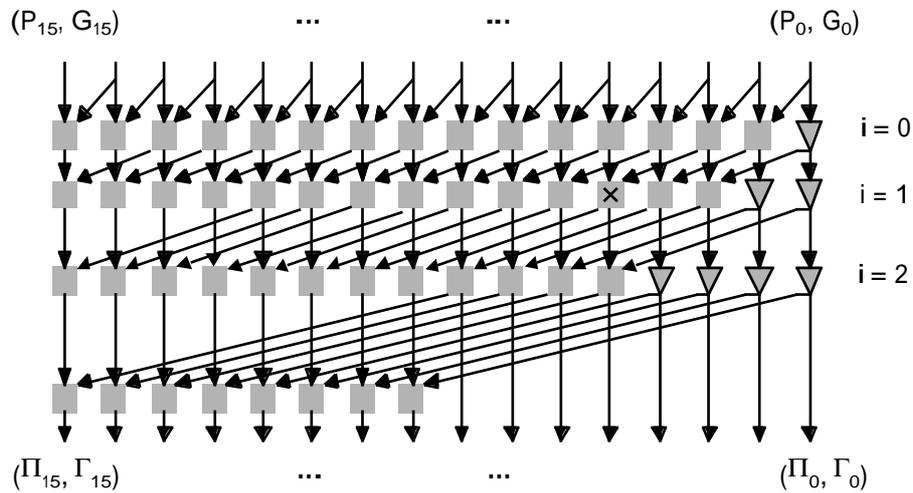
Figure 3.10. Structure de Kogge et Stone pour 16 bits
