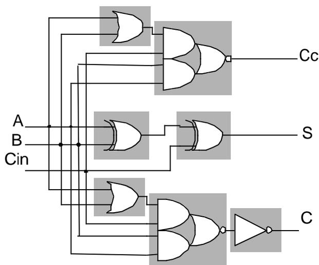
Figure 5.3. Cellule de FA avec retenue redondante et sans porte logique commune entre les différentes sorties
