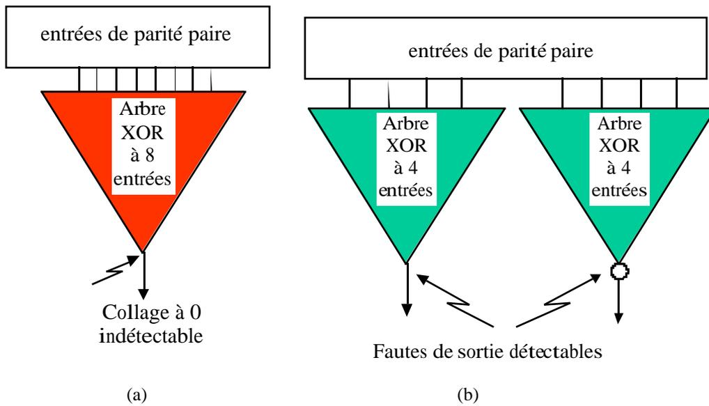
Figure 1.2. a) contrôleur de parité non auto-contrôlable
