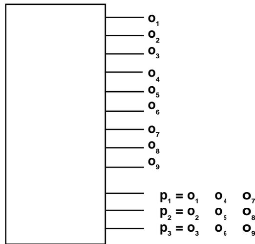
Figure 5.6. Codage à 3 bits de parité
