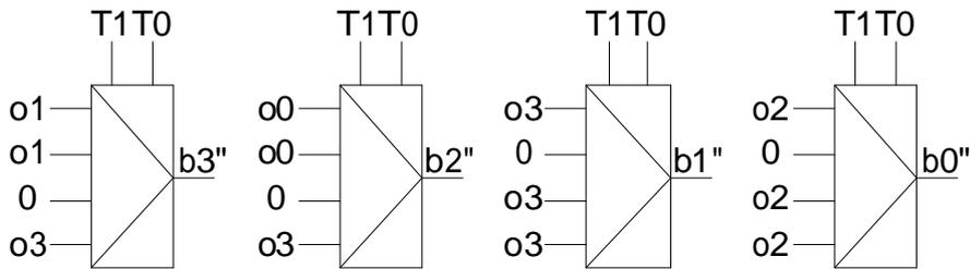
Figure 5.3. Un registre à décalage de deux positions à 4 bits
