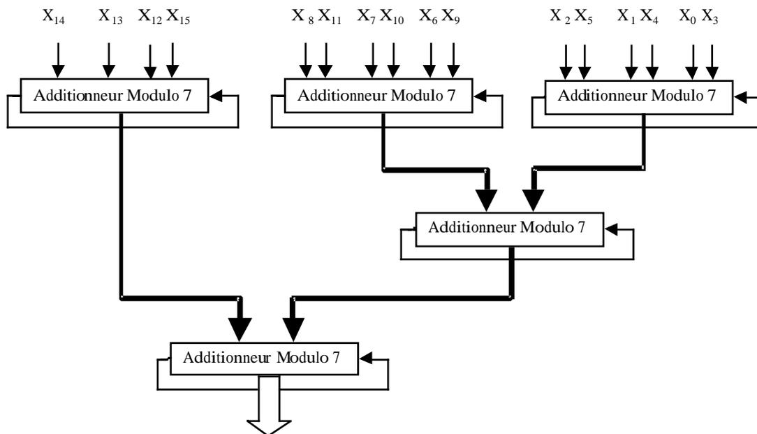
Figure 2.3. Générateur Modulo 7 à 16 bits
