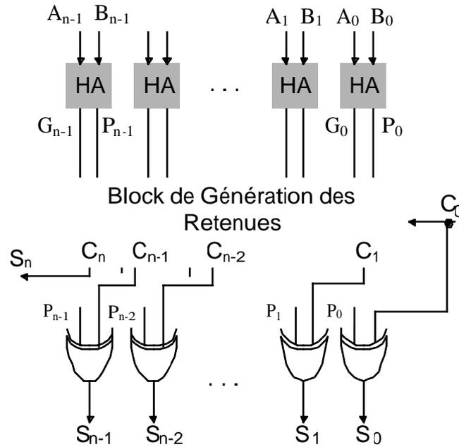
Figure 3.4. Schéma d'un CLA
