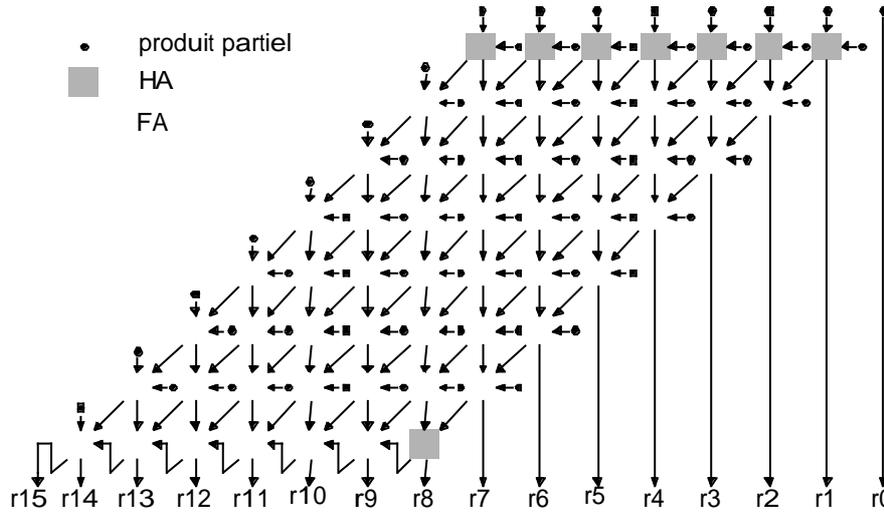
Figure 4.3. Multiplieur de Braun 8x8 bits
