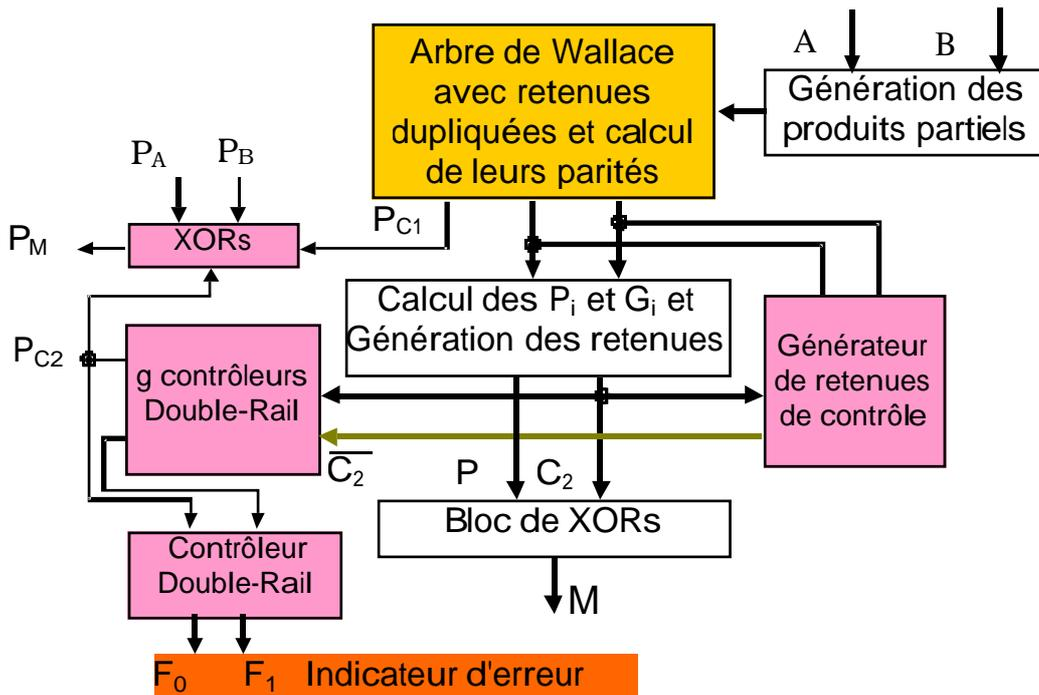
Figure 5.9. Multiplieur de Wallace basé sur la prédiction de parité avec un ou plusieurs bits de parité
