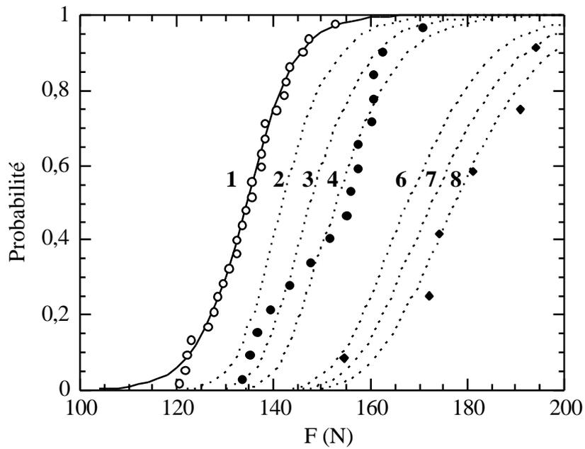
Fig.2.12 Courbe de probabilités de rupture des 1<sup>ers</sup> (o), 2<sup>èmes</sup> (•) et 3<sup>èmes</sup> (→) essais successifs des minicomposites SiC/SiC (Nombre  $i$  : courbe 1- $L_i(F)$ ).
