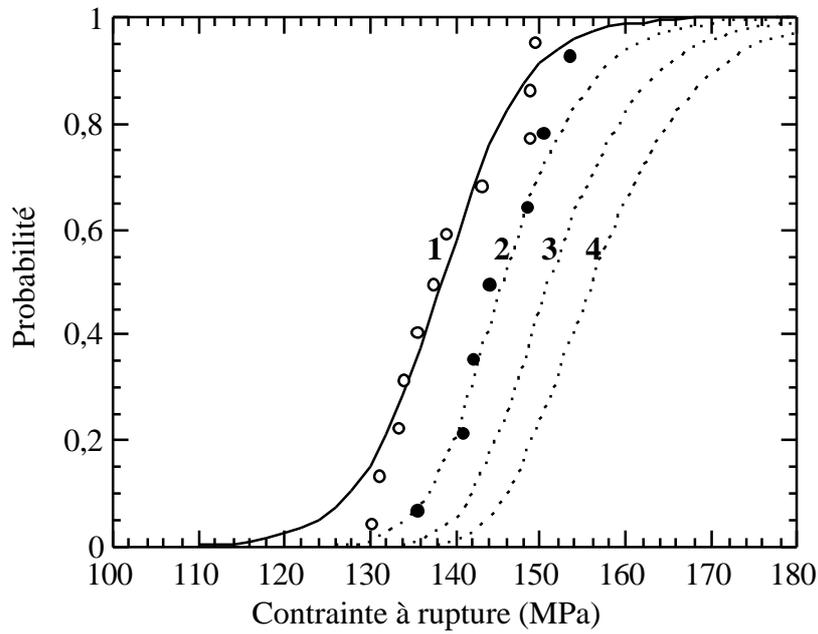
Fig.2.14 Distributions des contraintes de rupture obtenues pour des 1<sup>ers</sup> (o), 2<sup>èmes</sup> (•) essais successifs du composite SiC/SiC 0,2% (Nombre i : courbe 1- $L_i(F)$ ).
