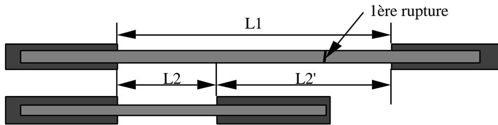
Fig.2.9 Schéma des échantillons successifs préparés à partir d'éprouvettes rompues ( $L_2'$  est la longueur non testée pendant le 2<sup>ème</sup> essai).
