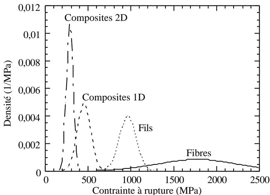
Fig.2.1 Fonctions de densité des contraintes à rupture des fibres SiC aux composites 2D tissés SiC/SiC (Données [Lis94] pour les fibres SiC NLM 202 et minicomposite SiC/SiC, et **(Partie II-4)** pour le composite 2D tissé SiC/SiC).
