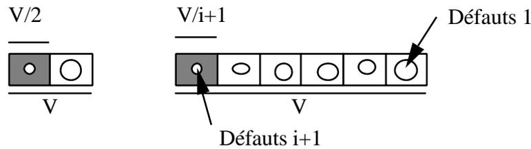
Fig.1.10 Sélection des défauts en fonction du volume.
