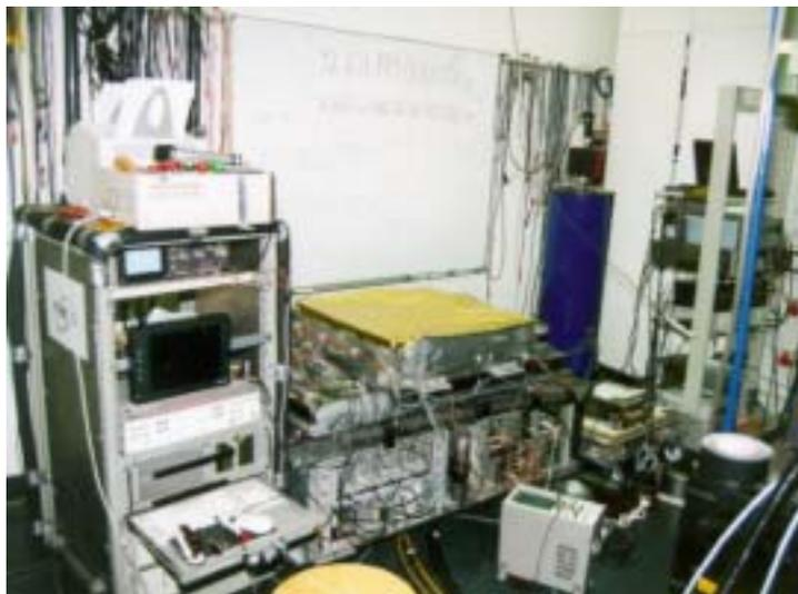
FIG. 2.1 – Description générale de la fontaine PHARAO : l’horloge comprend (de gauche à droite) un ordinateur de contrôle, un banc optique et son électronique de commande, un tube horloge et un rack de génération de la micro-onde
