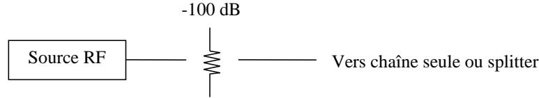
FIG. 9.10 – Schéma de l'atténuation de la source RF : on place un atténuateur de 100 dB à une température T_0 = 4.2 K . Une fois atténué, le signal est envoyé soit vers une chaîne de mesure, soit vers le séparateur.
