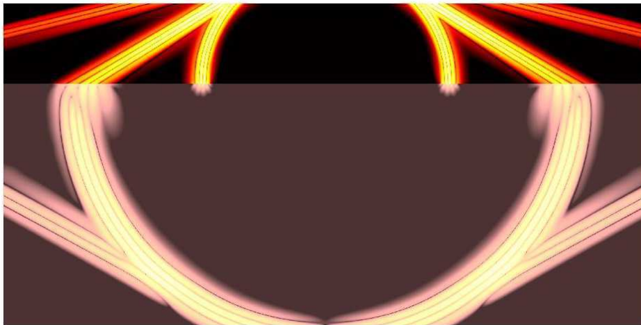
Figure 2.10 : Absorption par les PML des ondes de volumes et d'interface (dynamique: 80 dB).
