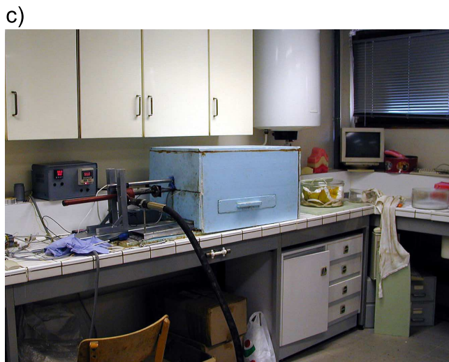
Figure 2-9 : Dispositif expérimental au laboratoire Dynamique de la Lithosphère, université Claude Bernard. a) Schéma de l'appareil. b) Vue d'ensemble avec l'ordinateur et le système d'acquisition. c) La machine sous son capot de polystyrène isolant.
