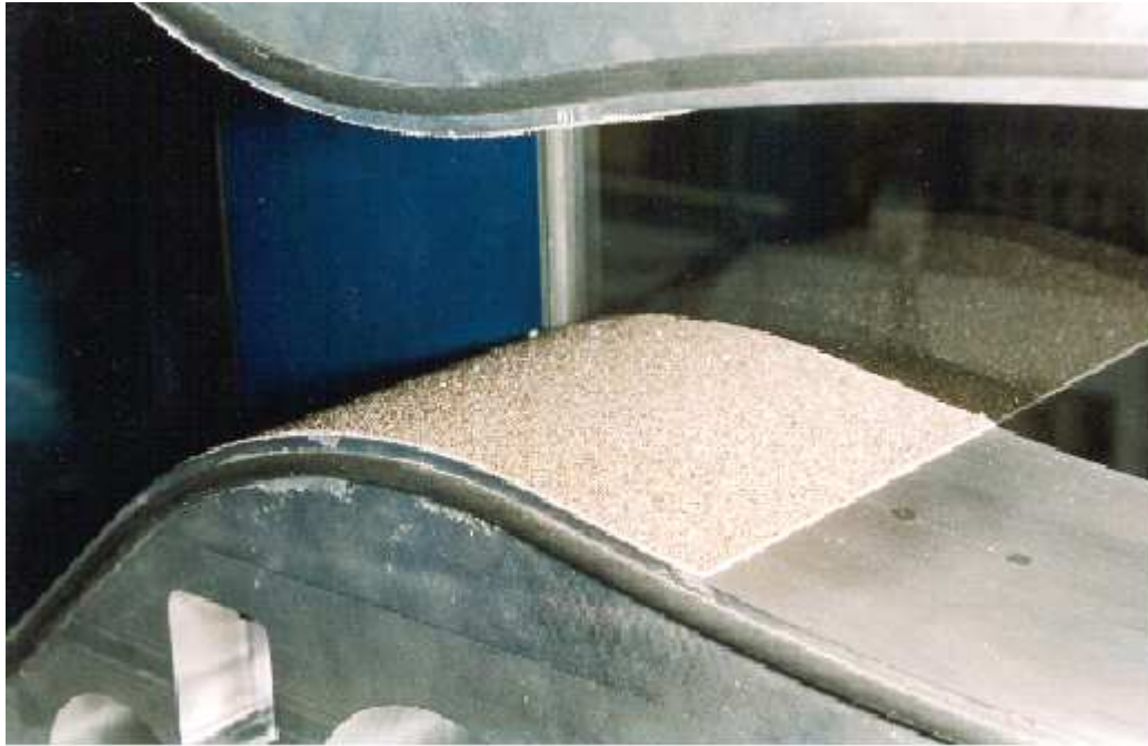
Figure 3-8 – Photographie montrant l'application du papier Carborundum dans la veine.
