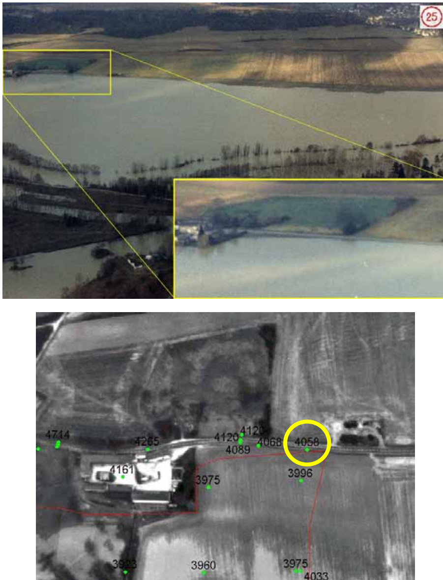
Figure 11-8 : Analyse du point coté ayant conduit à limiter les bornes Max des estimations à l'amont du pont de Pommier.
