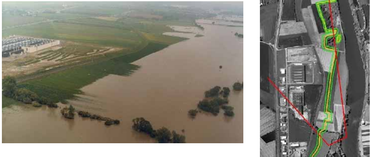
Figure 9-6 : exemple de positionnement des limites d'inondation (en rouge : emprise de la photographie, en jaune : limite d'inondation extraite et en vert : zone d'imprécision de localisation de la limite obtenue par une zone tampon)
