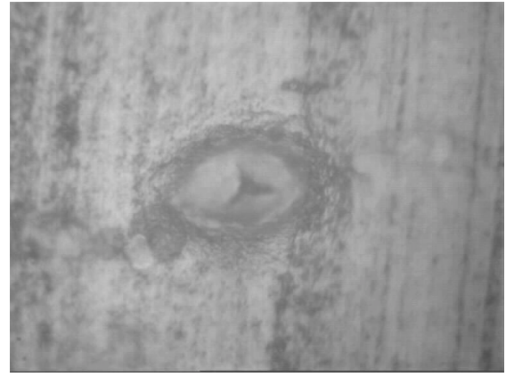
d. Agglomérat testé par un indenteur TCC
