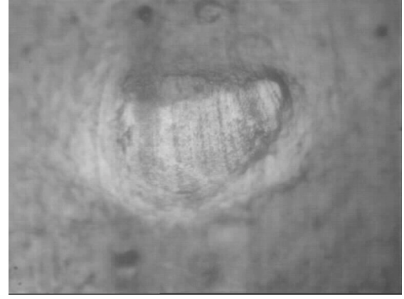
b. Agglomérat testé par un indenteur Berkovich
