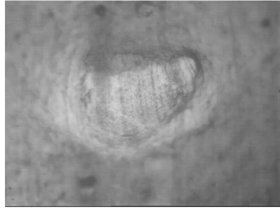
b. Agglomérat testé par un indenteur Berkovich
