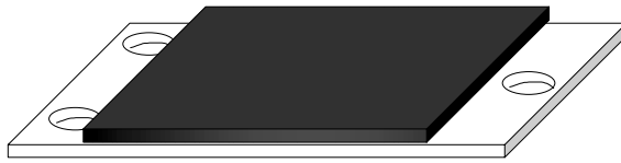
Figure 6 : Schéma d'une éprouvette d'essai pour une épaisseur d'éprouvette de 2 mm.
