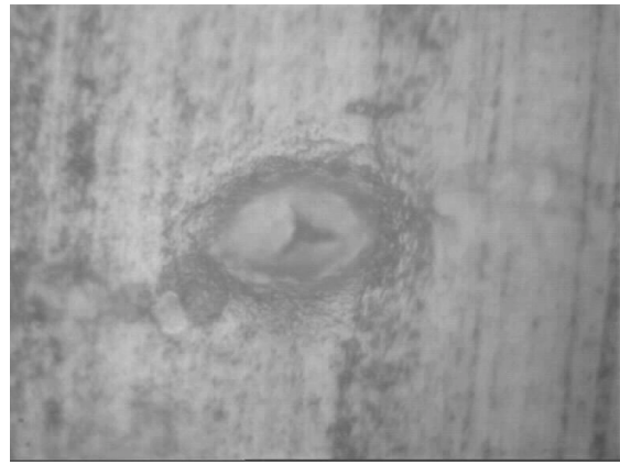
d. Agglomérat testé par un indenteur TCC
