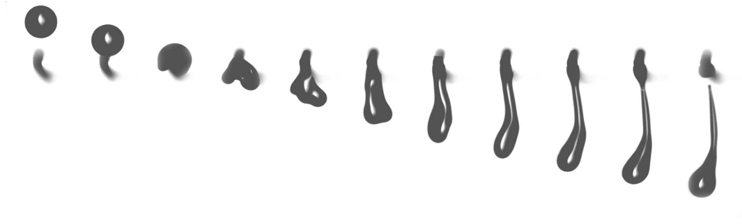
FIG. 4.14: Goutte d'huile peu visqueuse ( \eta = 5 \text{ mPa.s} ) de 0.7 mm de rayon tombant sur une fibre. La vitesse de chute est plus grande que la vitesse de capture ( V > V^{**} ) et la goutte n'est pas totalement capturée. 2 ms sépare chaque image.
