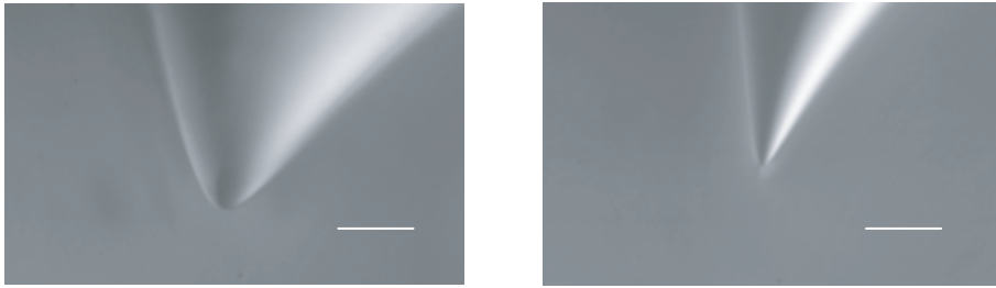
FIG. 6.13: Photographies du ménisque d'air pointant dans le glycérol. Le trait blanc correspond à 200 \mu\text{m} . La vitesse d'entraînement vaut 14 cm/s sur la photo de gauche et 22 cm/s sur la photo de droite.
