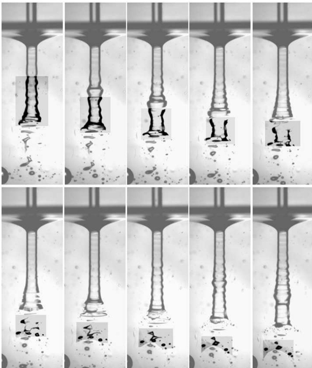
FIG. 8.13: Évolution d'une tranche d'air (en grisé) qui se déstabilise pour former des bulles. L'intervalle entre les photos est de 4 ms. La longueur de la trompette est de l'ordre de 15 mm. Le jet de 1.5 mm de diamètre d'huile silicone ( \eta = 0.35 Pa.s) tombe à 1.76 m/s dans un bain du même liquide. Nous remarquons que la trompette est ondulée, nous discutons ce point dans l'annexe C.
