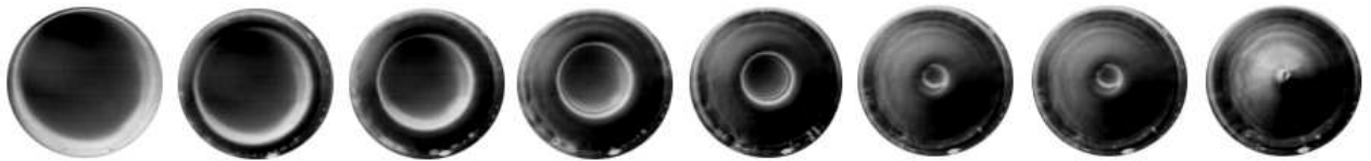
FIG. 1.17: Série de photos vue de dessus. Un cratère présent au centre du tube se referme avant que n'apparaisse le jet de liquide (dernière photo). L'écart entre les photos est de 2.7 ms et le rayon du tube est de 1 cm.
