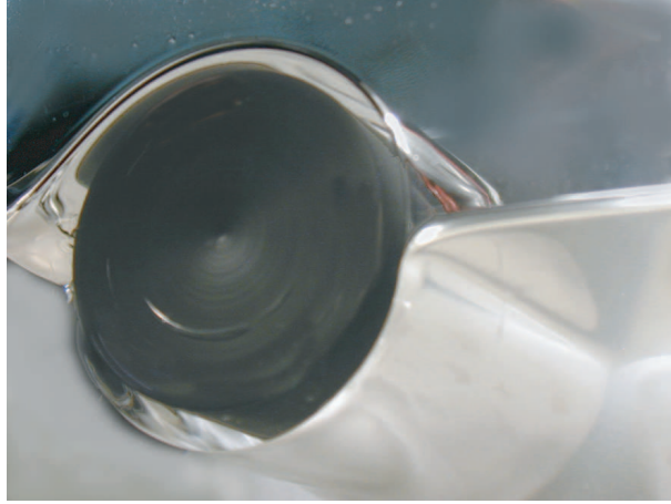
FIG. 7.3: Photographie du rouleau et de la lame d'air entraînée prise par en-dessous, et de trois-quart.
