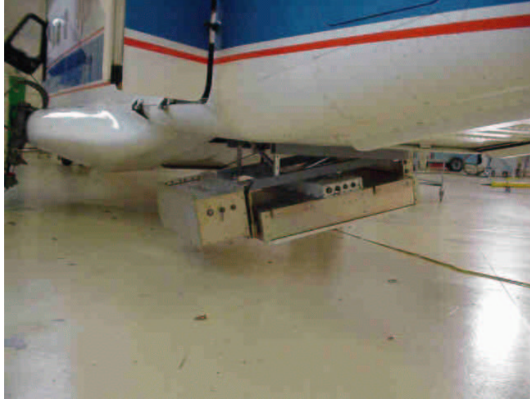
FIG. 7.3: Le STARRS installé sur le Donier 228 du DLR (campagnes EuroSTARRS).
