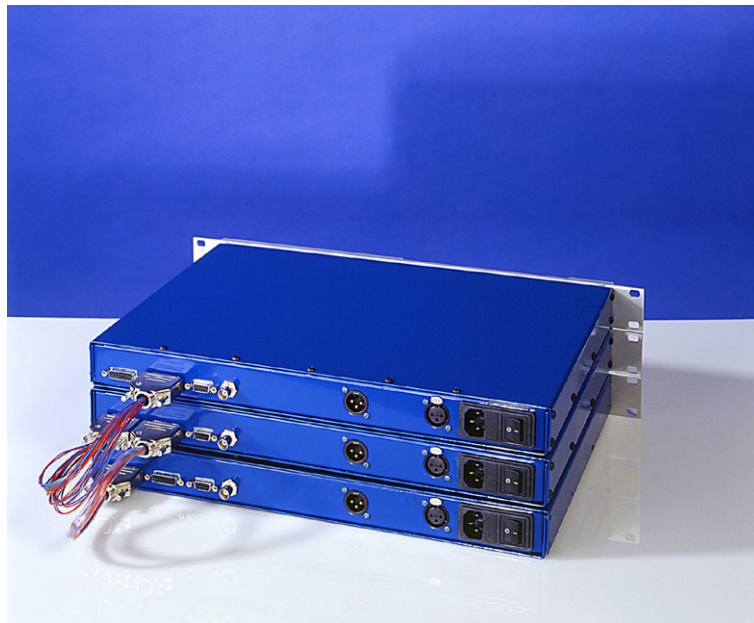
Figure 4.5 – Photo de la connectique arrière de l'HARMO
