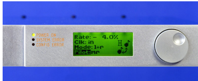
Figure 4.8 – Photo de l'affichage de l'HARMO avec ses 4 paramètres
