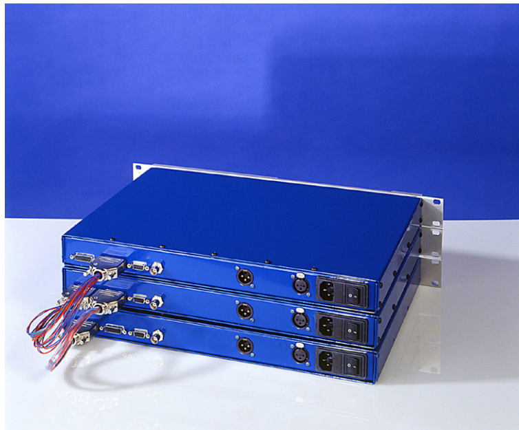
Figure 4.5 – Photo de la connectique arrière de l'HARMO
