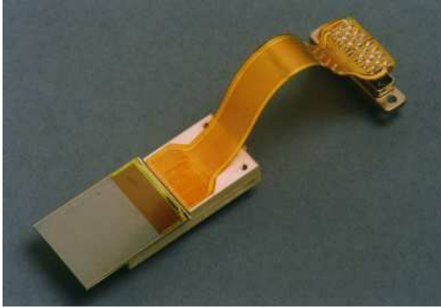
Figure I-2.15: Matrice CCD possédant une zone d'acquisition de 600 \text{ pixels} \times 600 \text{ pixels} de 40 \times 40 \mu\text{m}^2 . Le détecteur que nous utilisons est formé de six de ces matrices sous la forme de deux colonnes verticales adjacentes. Le cablage, qui relie la matrice à son électronique d'acquisition, est enveloppé de Kapton flexible, pour permettre à la matrice CCD d'être mise sous vide.
