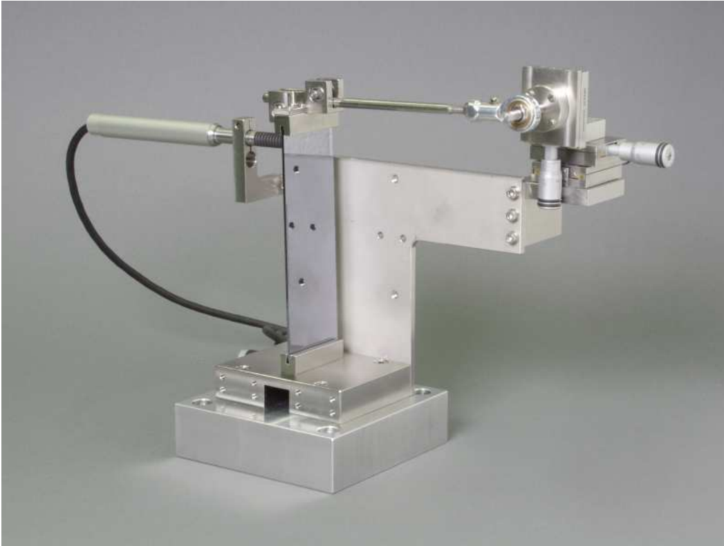
Figure I-1.20: Nouveau courbeur utilisé pour le cristal du spectromètre FOCAL. Un palpeur Heidenhaim permet de détecter toutes dérives provenant d'un problème mécanique dans le système de torsion.
