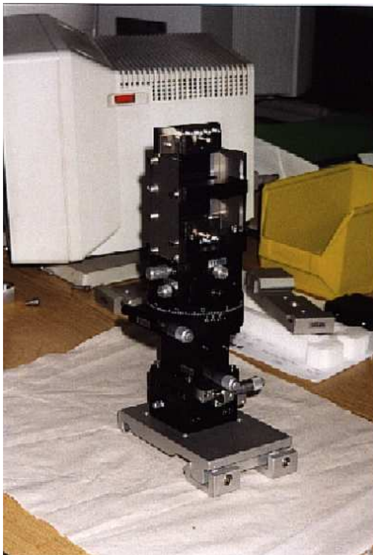
Figure I-1.12: Support du cristal courbe Si(220) de FOCAL. On remarque notamment les différents systèmes micrométriques servant pour le positionnement du cristal.
