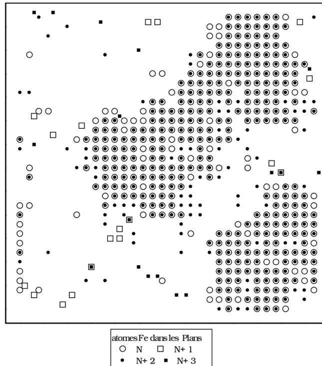
Figure III-21: 4 plans successifs (001) montrant la présence de grains pur en Co et de grains ordonnés selon la phase B2 stoechiométrique.
